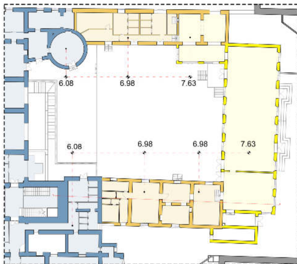
Figura 18 - Schema delle quote di calpestio del Corpo D (azzurro), del Corpo C1 e C2 (arancio) e del Corpo B (Giallo)
