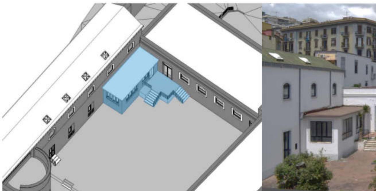
Figura 16 - Individuazione della porzione rettangolare annessa al Corpo B - Modello BIM e Foto dello Stato di Fatto
