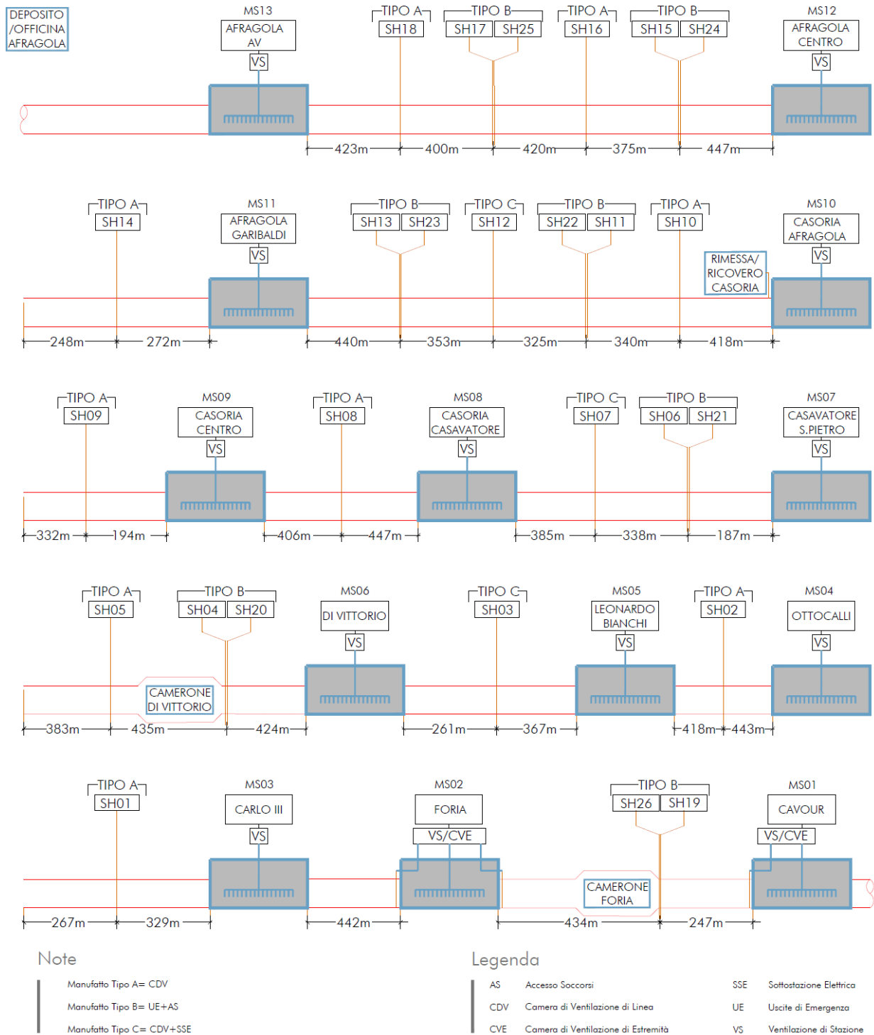
Figura 3 - Schematico della linea con indicazione del numero e tipologia di manufatti di linea
