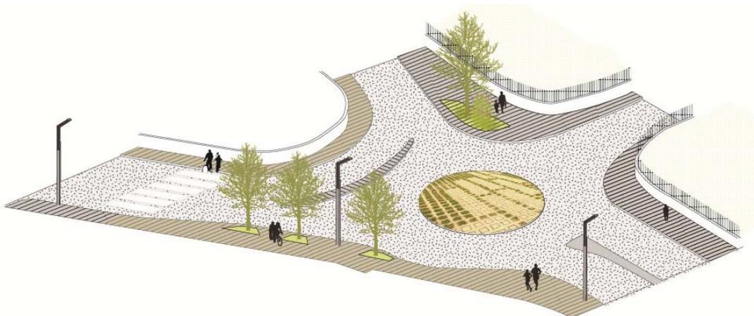
Schema tipologico da progetto preliminare: elementi di riqualificazione delle intersezioni stradali.
