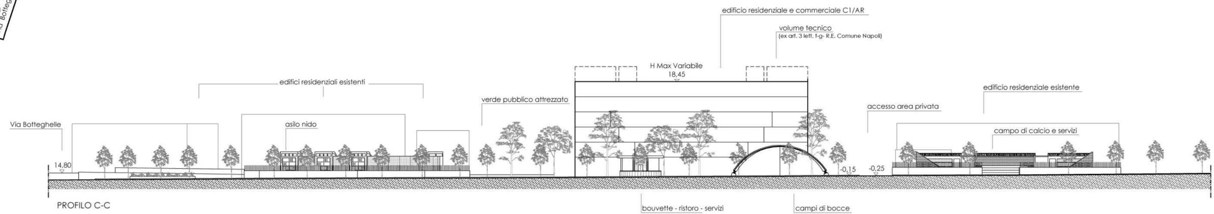
Il **Profilo Altimetrico di Progetto** individua l'andamento altimetrico, di massima, in funzione delle quote di sistemazione dei lotti e delle altezze massime consentite dei volumi edilizi di progetto
