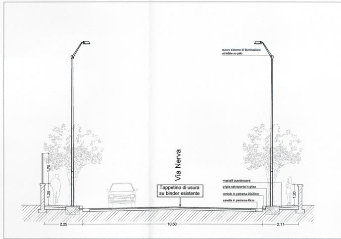
sezione di progetto rapp. 1:100
