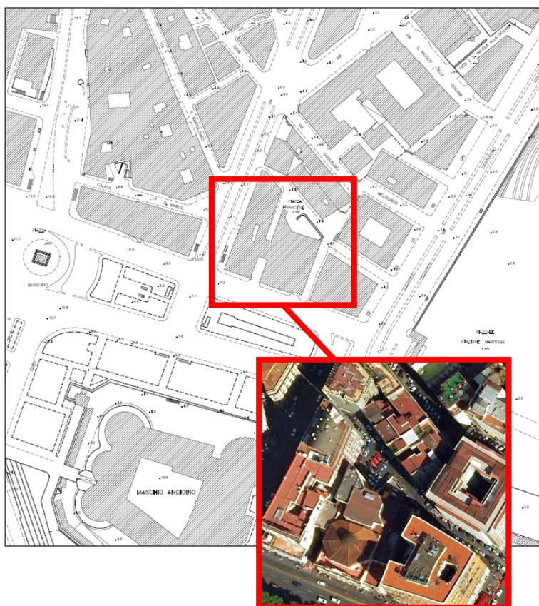
La recinzione di cantiere dovrà essere realizzata nell'angolo SUD-EST del cortile racchiudendo un'area di circa 20 mq. L'allestimento del cantiere non prevede il posizionamento di bagni e spogliatoi, potendosi utilizzare a tale scopo quelli presenti nel cortile. Nella seguente planimetria dell'area di cantiere è riportata l'indicazione di massima dell'ubicazione di:
