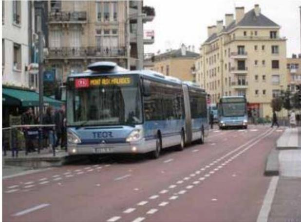
Fonte: Finn B., Et Al. Final Report, COST action TU0603, 2011 La guida dei veicoli è di tipo semi-automatico; viene utilizzato un gruppo ottico di riconoscimento della direzione di via, dettata da due linee tratteggiate poste centralmente alla corsia L'automatismo di guida viene tuttavia attivato esclusivamente in corrispondenza delle fermate per consentire un perfetto allineamento dei pianali dei veicoli alle banchine.
