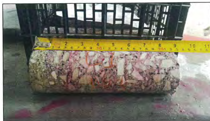
Figura 3: Prova di carbonatazione C1
