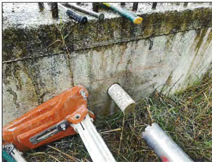
Figura 1: Estrazione carota cls C1
