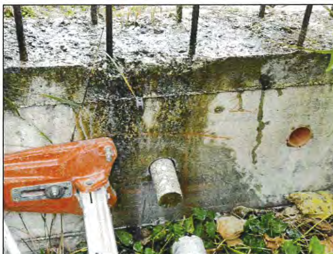
Figura 2: Estrazione carota cls C2
