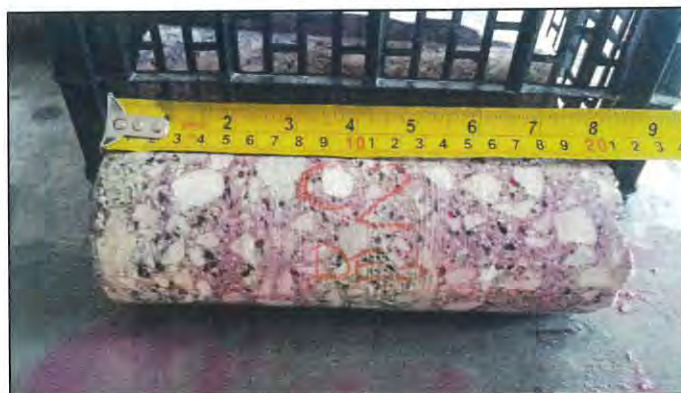
Figura 4: Prova di carbonatazione C2
