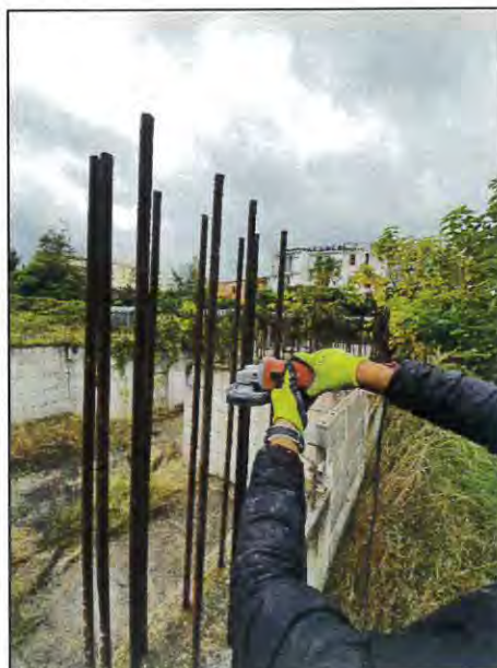
Figura 5: Prelievo barra di armatura
