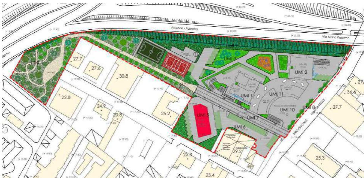
Fig. 18: calcolo delle superfici permeabili del PUA
