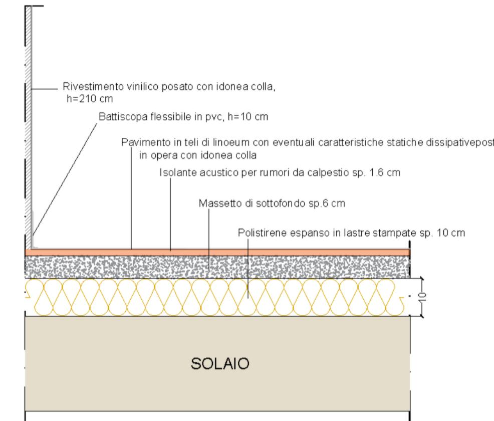
Pavimento in linoleum con eventuali caratteristiche statiche dissipative. Battiscopa flessibile in pvc di raccordo al rivestimento murario
