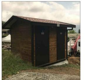
Il blocco bagni previsto in prossimità dell'ingresso, a servizio dei fruitori dell'orto sociale, non ancorato al suolo, removibile, destinato all'utilizzo da parte di una persona singola, munito di un serbatoio per i rifiuti non collegato alla rete fognaria, garantisce il rispetto dei requisiti previsti dalla norma UNI EN 16194:2012 (BAGNI MOBILI NON COLLEGATI ALLA RETE FOGNARIA - Requisiti per i prodotti ed i servizi necessari per l'utilizzo di bagni mobili e relativi prodotti sanitari).
