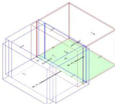
Calcolo di isolamento per via aerea tra il vano emittente "Secondo Piano-P2\_ Stanza visite" e il vano ricevente "Primo Piano-P1\_ Refetazione/Amministrazione"
