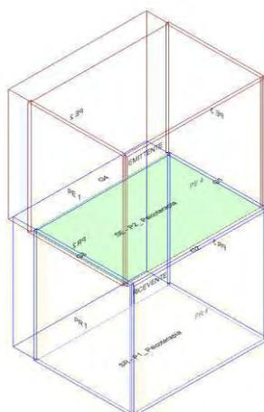
Calcolo di isolamento per via aerea tra il vano emittente "Secondo Piano-P2\_ Psicoterapia" e il vano ricevente "Primo Piano-P1\_ Psicoterapia"
