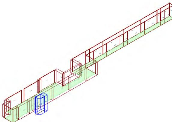
Calcolo di isolamento per via aerea tra il vano emittente "Primo Piano-P1\_ Attesa" e il vano ricevente "Piano Terra-PT\_ Comandi area tecnica"
