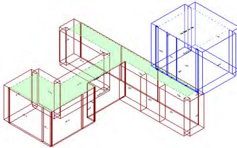
Calcolo di isolamento al calpestio tra il vano emittente "Primo Piano-P1\_Corridoio" e il vano ricevente "Piano Terra-PT\_Sala RM"
