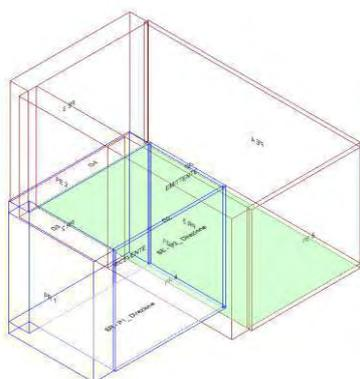
Calcolo di isolamento per via aerea tra il vano emittente "Secondo Piano-P2\_ Direzione" e il vano ricevente "Primo Piano-P1\_ Direzione"
