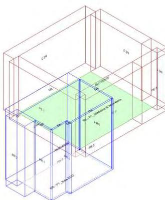
Calcolo di isolamento per via aerea tra il vano emittente "Primo Piano-P1\_ Medicina di laboratorio" e il vano ricevente "Piano Terra-PT\_ Sala ECO"
