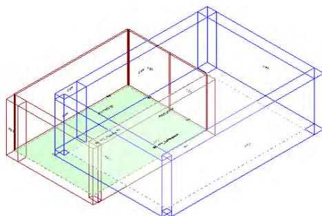
Calcolo di isolamento al calpestio tra il vano emittente "Secondo Piano-P2\_ Palestra" e il vano ricevente "Primo Piano-P1\_Laboratorio "
