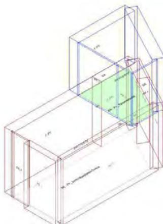
Calcolo di isolamento per via aerea tra il vano emittente "Piano Terra-PT\_ Servizi/Spogliatoio Donne" e il vano ricevente "Primo Piano-P1\_ Psicomotrocità"
