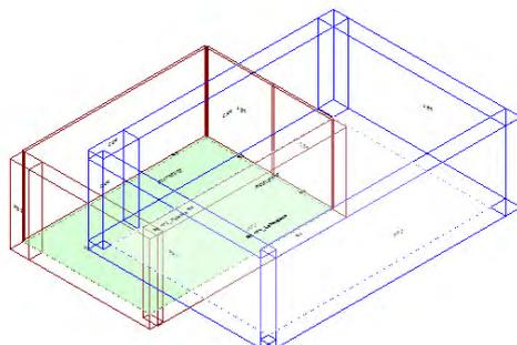
Calcolo di isolamento per via aerea tra il vano emittente "Secondo Piano-P2\_ Palestra" e il vano ricevente "Primo Piano-P1\_Laboratorio "
