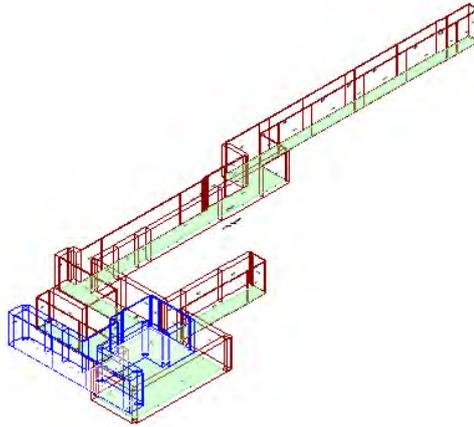
Calcolo di isolamento al calpestio tra il vano emittente "Secondo Piano-P2\_ Attesa/Corridoio" e il vano ricevente "Primo Piano-P1\_ Corridoio"
