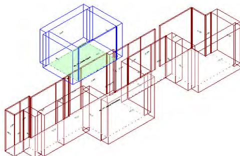
Calcolo di isolamento per via aerea tra il vano emittente "Piano Terra-PT\_ Attesa/Acettazione" e il vano ricevente "Primo Piano-P1\_ Studio medico"
