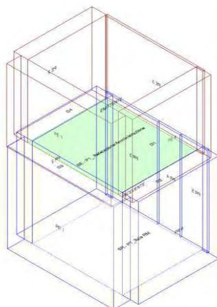
Calcolo di isolamento per via aerea tra il vano emittente "Primo Piano-P1\_ Refetazione/Amministrazione" e il vano ricevente "Piano Terra-PT\_Sala RM"
