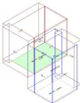
Calcolo di isolamento per via aerea tra il vano emittente "Primo Piano-P1\_ Direzione" e il vano ricevente "Piano Terra-PT\_ Ufficio"
