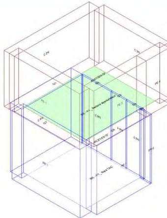
Calcolo di isolamento al calpestio tra il vano emittente "Primo Piano-P1\_ Settore specialistico" e il vano ricevente "Piano Terra-PT\_ Sala TAC"
