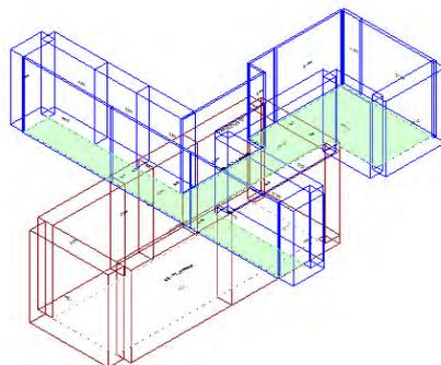
Calcolo di isolamento per via aerea tra il vano emittente "Piano Terra-PT\_Androne" e il vano ricevente "Primo Piano-P1\_Corridoio"
