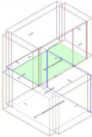
Calcolo di isolamento per via aerea tra il vano emittente "Secondo Piano-P2\_ Stanza terapia" e il vano ricevente "Primo Piano-P1\_ Refetazione/Amministrazione"
