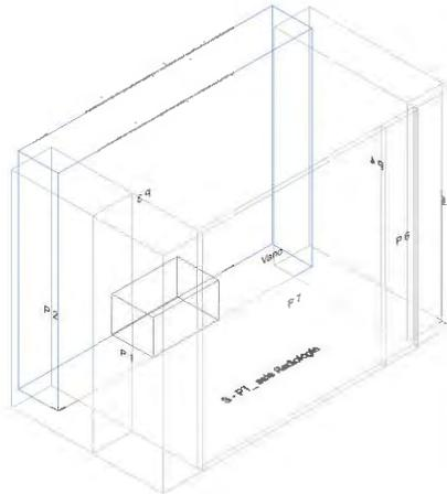
Calcolo di isolamento di facciata per il vano "Piano Terra-PT\_ sala Radiologia"
