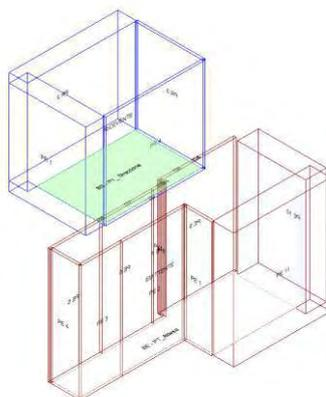
Calcolo di isolamento per via aerea tra il vano emittente "Piano Terra-PT\_Attesa" e il vano ricevente "Primo Piano-P1\_Direzione"
