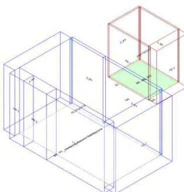
Calcolo di isolamento per via aerea tra il vano emittente "Primo Piano-P1\_ WC" e il vano ricevente "Piano Terra-PT\_ Attesa/Acettazione Riabilitazione"
