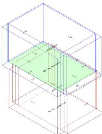
Calcolo di isolamento per via aerea tra il vano emittente "Primo Piano-P1\_ Locale PCR" e il vano ricevente "Secondo Piano-P2\_ Segreteria"
