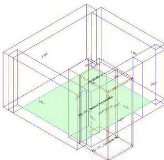
Calcolo di isolamento per via aerea tra il vano emittente "Piano Terra-PT\_ Comandi TAC" e il vano ricevente "Primo Piano-P1\_ Settore specialistico"
