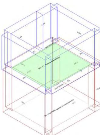
Calcolo di isolamento per via aerea tra il vano emittente "Piano Terra-Area NON oggetto di autorizzazione" e il vano ricevente "Primo Piano-P1\_ Settore specialistico"
