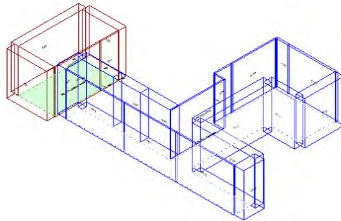
Calcolo di isolamento al calpestio tra il vano emittente "Secondo Piano-P2\_ Stanza terapia" e il vano ricevente "Primo Piano-P1\_ Corridoio"
