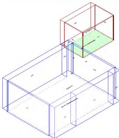
Calcolo di isolamento per via aerea tra il vano emittente "Primo Piano-P1\_ Psicomotrocità" e il vano ricevente "Piano Terra-PT\_ Palestra/semiconvitto"
