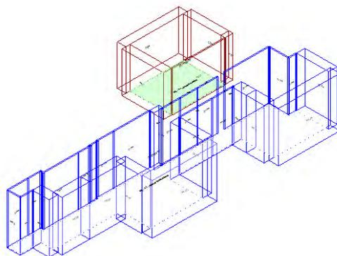
Calcolo di isolamento per via aerea tra il vano emittente "Primo Piano-P1\_ Studio medico" e il vano ricevente "Piano Terra-PT\_ Attesa/Accettazione"
