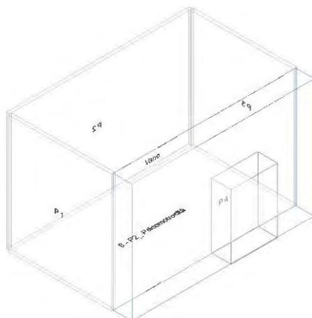
Calcolo di isolamento di facciata per il vano "Secondo Piano-P2\_ Psicomotrocità"
