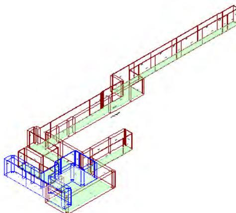
Calcolo di isolamento per via aerea tra il vano emittente "Secondo Piano-P2\_ Attesa/Corridoio" e il vano ricevente "Primo Piano-P1\_ Corridoio"
