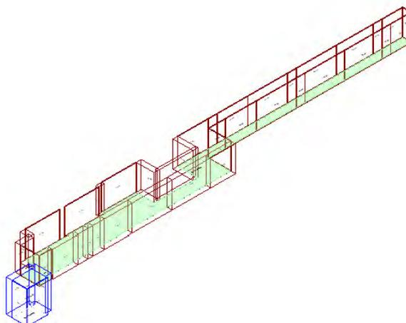
Calcolo di isolamento al calpestio tra il vano emittente "Primo Piano-P1\_ Attesa" e il vano ricevente "Piano Terra-PT\_ Ufficio"
