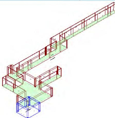
Calcolo di isolamento per via aerea tra il vano emittente "Secondo Piano-P2\_ Attesa/Corridoio" e il vano ricevente "Primo Piano-P1\_ Settore specialistico"
