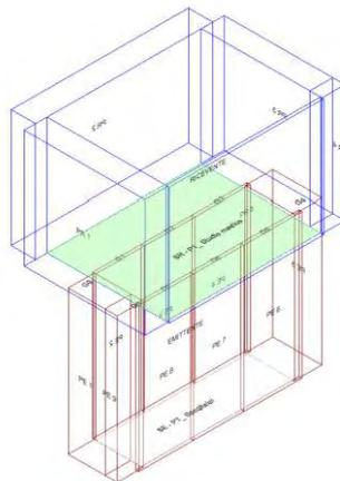
Calcolo di isolamento per via aerea tra il vano emittente "Piano Terra-PT\_ Spogliatoi" e il vano ricevente "Primo Piano-P1\_ Studio medico"
