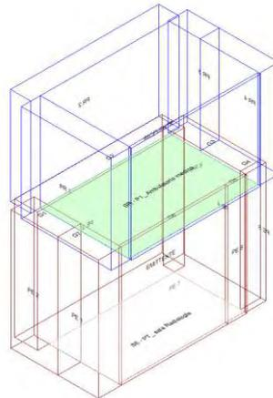
Calcolo di isolamento per via aerea tra il vano emittente "Piano Terra-PT\_ sala Radiologia" e il vano ricevente "Primo Piano-P1\_ Ambulatorio medico"
