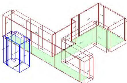
Calcolo di isolamento per via aerea tra il vano emittente "Primo Piano-P1\_Corridoio" e il vano ricevente "Piano Terra-PT\_Comandi RM"
