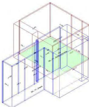
Calcolo di isolamento per via aerea tra il vano emittente "Primo Piano-P1\_ Spogliatoio/relax" e il vano ricevente "Piano Terra-PT\_Attesa"
