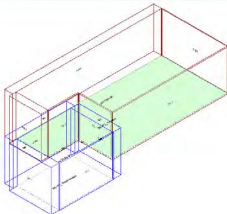
Calcolo di isolamento al calpestio tra il vano emittente "Secondo Piano-P2\_ Palestra" e il vano ricevente "Primo Piano-P1\_ Studio medico"
