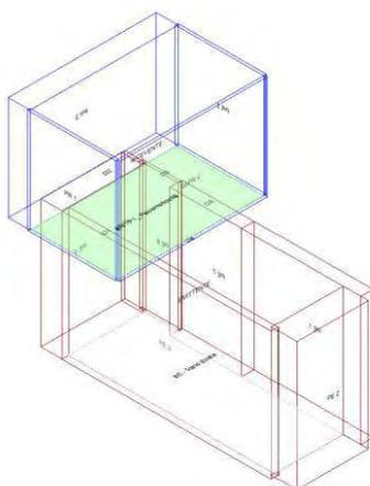
Calcolo di isolamento per via aerea tra il vano emittente "Piano Terra-Vano Scala" e il vano ricevente "Primo Piano-P1\_ Psicomotrocità"
