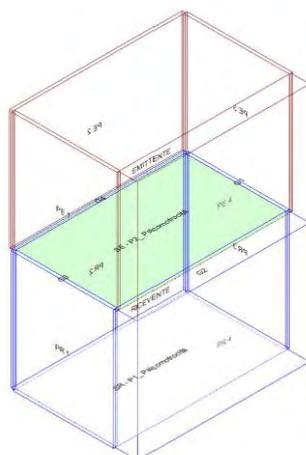
Calcolo di isolamento per via aerea tra il vano emittente "Secondo Piano-P2\_ Psicomotrocità" e il vano ricevente "Primo Piano-P1\_ Psicomotrocità"
