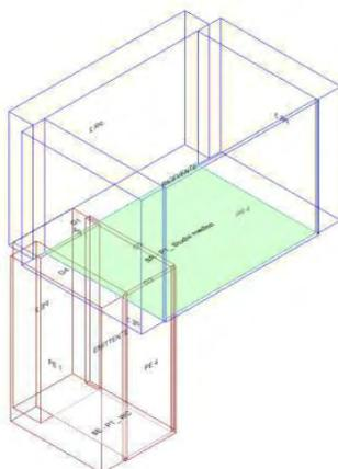
Calcolo di isolamento per via aerea tra il vano emittente "Piano Terra-PT\_ WC" e il vano ricevente "Primo Piano-P1\_ Studio medico"
