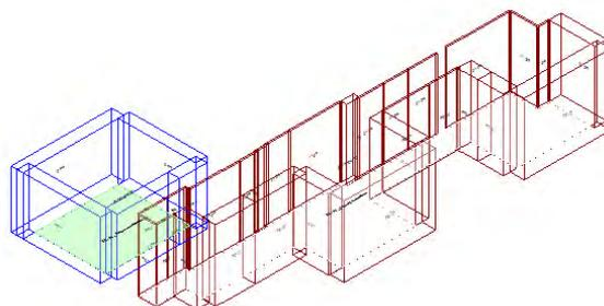
Calcolo di isolamento per via aerea tra il vano emittente "Piano Terra-PT\_ Attesa/Accettazione" e il vano ricevente "Primo Piano-P1\_ Settore specialistico"
