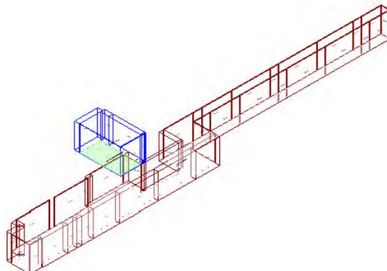
Calcolo di isolamento per via aerea tra il vano emittente "Primo Piano-P1\_ Attesa" e il vano ricevente "Secondo Piano-P2\_ BOX Massoteraia"
