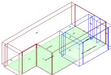
Calcolo di isolamento per via aerea tra il vano emittente "Secondo Piano-P2\_ Palestra" e il vano ricevente "Primo Piano-P1\_ Ambulatorio medico"
