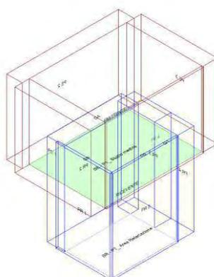
Calcolo di isolamento per via aerea tra il vano emittente "Primo Piano-P1\_ Studio medico" e il vano ricevente "Piano Terra-PT\_ Area Refertazione"
