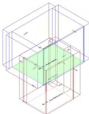
Calcolo di isolamento per via aerea tra il vano emittente "Piano Terra-PT\_ Area Refertazione" e il vano ricevente "Primo Piano-P1\_ Studio medico"
