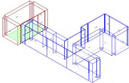
Calcolo di isolamento per via aerea tra il vano emittente "Secondo Piano-P2\_ Stanza terapia" e il vano ricevente "Primo Piano-P1\_ Corridoio"
