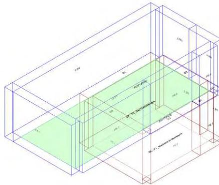
Calcolo di isolamento per via aerea tra il vano emittente "Primo Piano-P1\_ Medicina di laboratorio" e il vano ricevente "Secondo Piano-P2\_ Box Elettroterapia"
