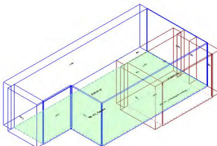
Calcolo di isolamento per via aerea tra il vano emittente "Primo Piano-P1\_ Ambulatorio medico" e il vano ricevente "Secondo Piano-P2\_ Palestra"
