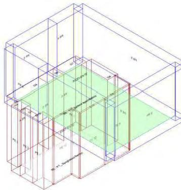
Calcolo di isolamento per via aerea tra il vano emittente "Piano Terra-PT\_ Spogliatoio/Servizi" e il vano ricevente "Primo Piano-P1\_ Settore specialistico"
