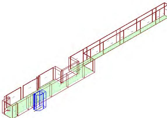
Calcolo di isolamento al calpestio tra il vano emittente "Primo Piano-P1\_ Attesa" e il vano ricevente "Piano Terra-PT\_ Comandi area tecnica"
