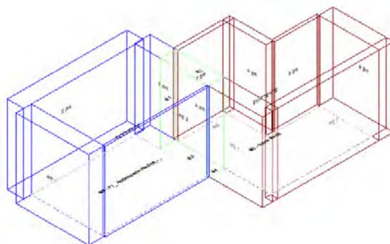
Calcolo di isolamento per via aerea tra il vano emittente "Primo Piano-Vano Scala" e il vano ricevente "Primo Piano-P1\_ Ambulatorio medico"
