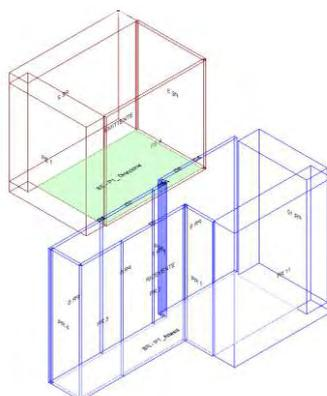
Calcolo di isolamento al calpestio tra il vano emittente "Primo Piano-P1\_ Direzione" e il vano ricevente "Piano Terra-PT\_Attesa"
