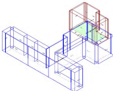
Calcolo di isolamento al calpestio tra il vano emittente "Secondo Piano-P2\_ BOX Isocinetica" e il vano ricevente "Primo Piano-P1\_ Corridoio"
