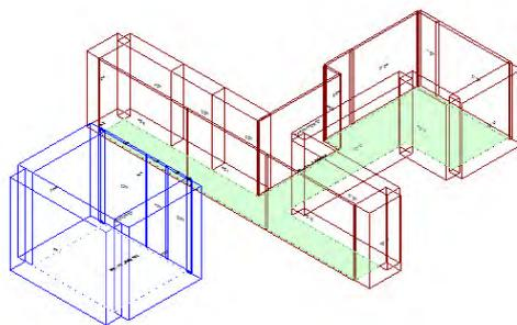
Calcolo di isolamento per via aerea tra il vano emittente "Primo Piano-P1\_ Corridoio" e il vano ricevente "Piano Terra-PT\_Sala RM"
