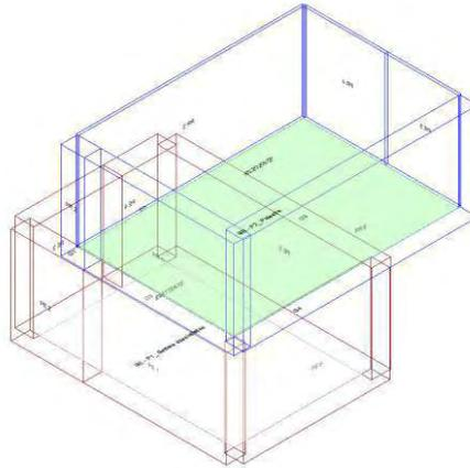
Calcolo di isolamento per via aerea tra il vano emittente "Primo Piano-P1\_ Settore specialistico" e il vano ricevente "Secondo Piano-P2\_ Palestra"
