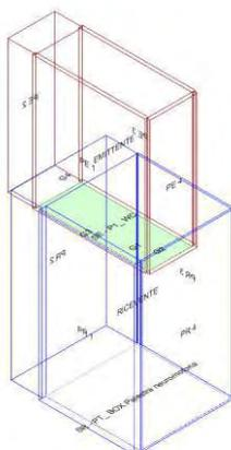
Calcolo di isolamento per via aerea tra il vano emittente "Primo Piano-P1\_ WC" e il vano ricevente "Piano Terra-PT\_ BOX Palestra neuromotoria"
