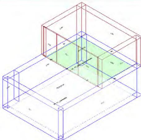
Calcolo di isolamento al calpestio tra il vano emittente "Secondo Piano-P2\_ Box Terapia strumentale" e il vano ricevente "Primo Piano-P1\_ Laboratorio "
