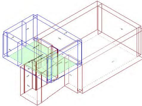
Calcolo di isolamento per via aerea tra il vano emittente "Piano Terra-PT\_ Accettazione" e il vano ricevente "Primo Piano-P1\_ Settore specialistico"
