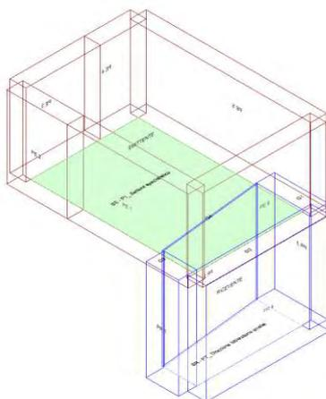
Calcolo di isolamento per via aerea tra il vano emittente "Primo Piano-P1\_ Settore specialistico" e il vano ricevente "Piano Terra-PT\_ Direzione laboratorio analisi"
