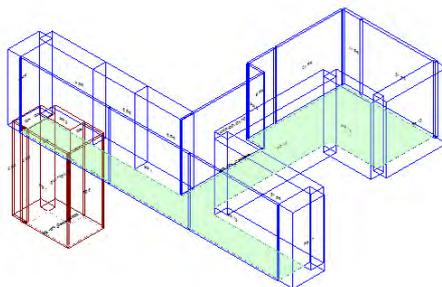
Calcolo di isolamento per via aerea tra il vano emittente "Piano Terra-PT\_Comandi RM" e il vano ricevente "Primo Piano-P1\_Corridoio"
