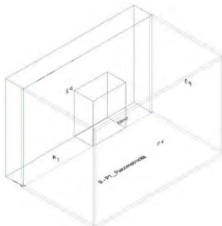
Calcolo di isolamento di facciata per il vano "Primo Piano-P1\_ Psicomotrocità"
