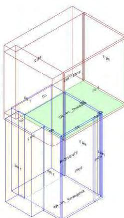
Calcolo di isolamento per via aerea tra il vano emittente "Primo Piano-P1\_ Direzione" e il vano ricevente "Piano Terra-PT\_ Emergenza"
