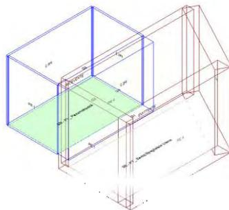
Calcolo di isolamento per via aerea tra il vano emittente "Piano Terra-PT\_ Servizi/Spogliatoio Uomo" e il vano ricevente "Primo Piano-P1\_Psicomotrocità"
