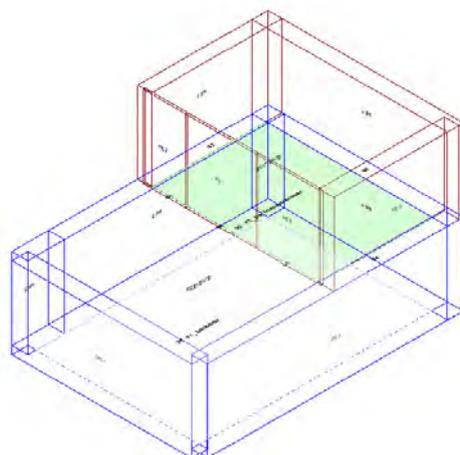
Calcolo di isolamento per via aerea tra il vano emittente "Secondo Piano-P2\_ Box Terapia strumentale" e il vano ricevente "Primo Piano-P1\_ Laboratorio "
