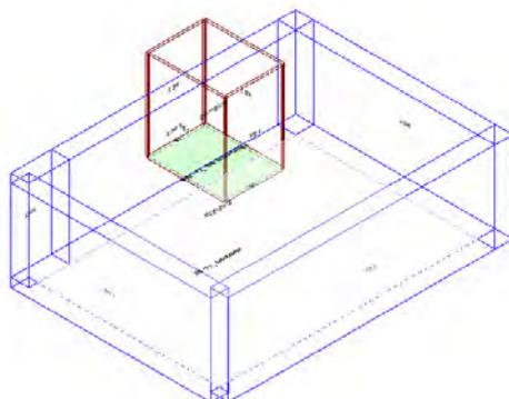
Calcolo di isolamento al calpestio tra il vano emittente "Secondo Piano-P2\_ Box Tecarterapia" e il vano ricevente "Primo Piano-P1\_ Laboratorio "
