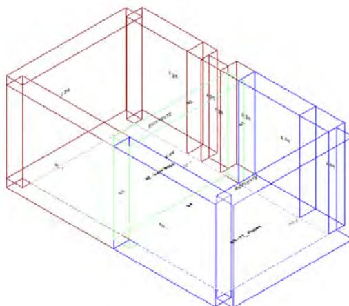
Calcolo di isolamento per via aerea tra il vano emittente "Piano Terra-Vano Scala" e il vano ricevente "Piano Terra-PT\_ Prelievi"
