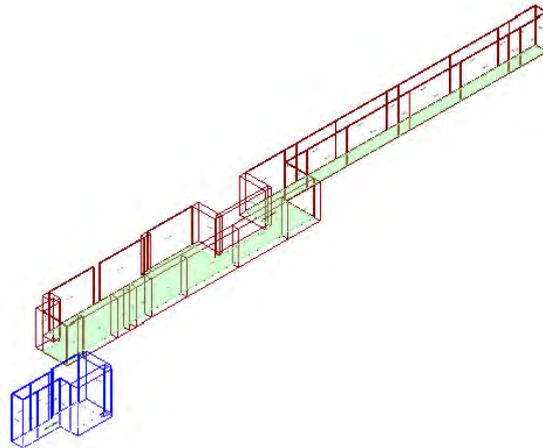
Calcolo di isolamento per via aerea tra il vano emittente "Primo Piano-P1\_ Attesa" e il vano ricevente "Piano Terra-PT\_ Attesa"
