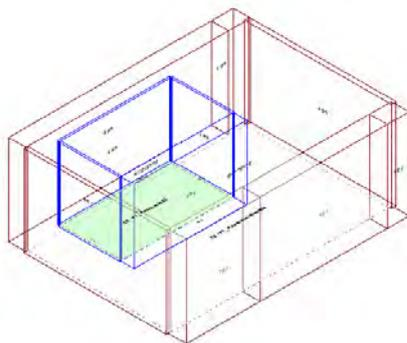
Calcolo di isolamento per via aerea tra il vano emittente "Piano Terra-PT\_ Palestra/semiconvitto" e il vano ricevente "Primo Piano-P1\_ Psicomotrocità"
