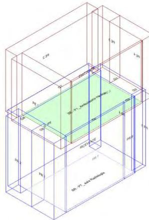
Calcolo di isolamento per via aerea tra il vano emittente "Primo Piano-P1\_ Ambulatorio medico" e il vano ricevente "Piano Terra-PT\_ sala Radiologia"
