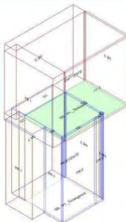
Calcolo di isolamento al calpestio tra il vano emittente "Primo Piano-P1\_ Direzione" e il vano ricevente "Piano Terra-PT\_Emergenza"
