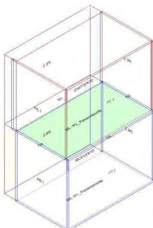
Calcolo di isolamento al calpestio tra il vano emittente "Secondo Piano-P2\_ Psicomotrocità" e il vano ricevente "Primo Piano-P1\_ Psicomotrocità"
