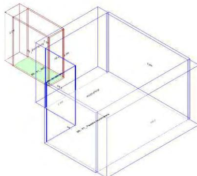
Calcolo di isolamento al calpestio tra il vano emittente "Primo Piano-P1\_ WC" e il vano ricevente "Piano Terra-PT\_ Palestra neuromotoria"
