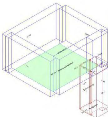
Calcolo di isolamento per via aerea tra il vano emittente "Piano Terra-PT\_ Spogliatoio" e il vano ricevente "Primo Piano-P1\_ Settore specialistico"
