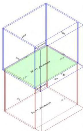
Calcolo di isolamento per via aerea tra il vano emittente "Primo Piano-P1\_ Psicoterapia" e il vano ricevente "Secondo Piano-P2\_ Psicoterapia"
