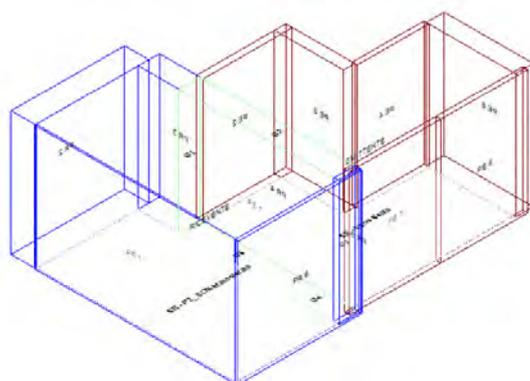
Calcolo di isolamento per via aerea tra il vano emittente "Secondo Piano-Vano Scala" e il vano ricevente "Secondo Piano-P2\_ BOX Massoteriaia"
