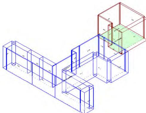
Calcolo di isolamento per via aerea tra il vano emittente "Secondo Piano-P2\_ WC Utenti" e il vano ricevente "Primo Piano-P1\_ Corridoio"
