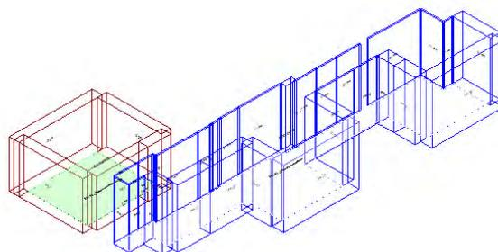
Calcolo di isolamento al calpestio tra il vano emittente "Primo Piano-P1\_ Settore specialistico" e il vano ricevente "Piano Terra-PT\_ Attesa/Accettazione"
