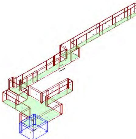
Calcolo di isolamento al calpestio tra il vano emittente "Secondo Piano-P2\_ Attesa/Corridoio" e il vano ricevente "Primo Piano-P1\_ Settore specialistico"
