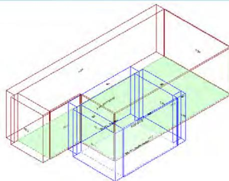
Calcolo di isolamento per via aerea tra il vano emittente "Secondo Piano-P2\_ Palestra" e il vano ricevente "Primo Piano-P1\_ Studio medico"
