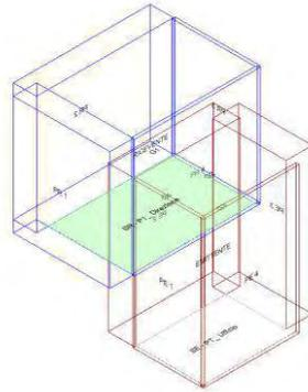
Calcolo di isolamento per via aerea tra il vano emittente "Piano Terra-PT\_ Ufficio" e il vano ricevente "Primo Piano-P1\_Direzione"
