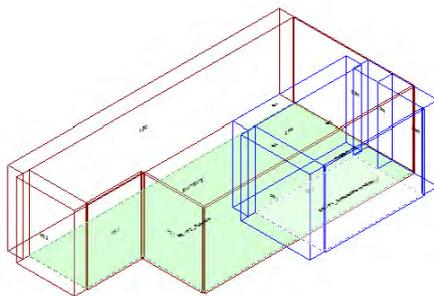
Calcolo di isolamento al calpestio tra il vano emittente "Secondo Piano-P2\_ Palestra" e il vano ricevente "Primo Piano-P1\_ Ambulatorio medico"
