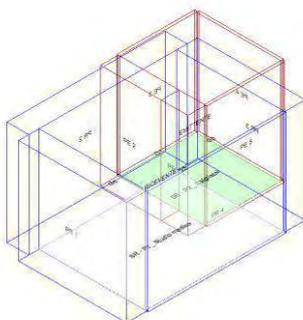
Calcolo di isolamento per via aerea tra il vano emittente "Secondo Piano-P2\_ Spigliatoi" e il vano ricevente "Primo Piano-P1\_ Studio medico"
