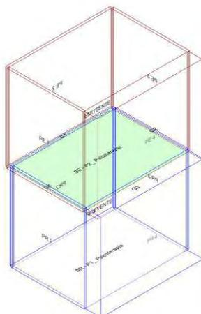
Calcolo di isolamento al calpestio tra il vano emittente "Secondo Piano-P2\_ Psicoterapia" e il vano ricevente "Primo Piano-P1\_ Psicoterapia"
