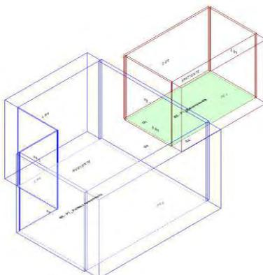
Calcolo di isolamento per via aerea tra il vano emittente "Primo Piano-P1\_ Psicomotrocità" e il vano ricevente "Piano Terra-PT\_ Palestra neuromotoria"
