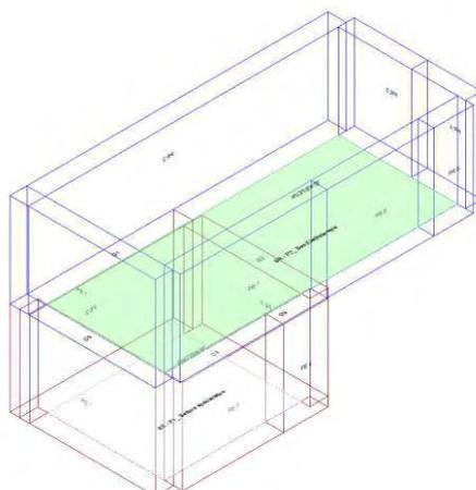
Calcolo di isolamento per via aerea tra il vano emittente "Primo Piano-P1\_ Settore specialistico" e il vano ricevente "Secondo Piano-P2\_ Box Elettroterapia"
