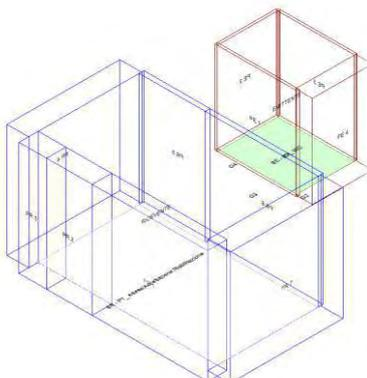
Calcolo di isolamento al calpestio tra il vano emittente "Primo Piano-P1\_ WC" e il vano ricevente "Piano Terra-PT\_ Attesa/Acettazione Riabilitazione"
