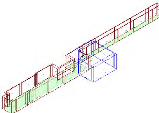
Calcolo di isolamento al calpestio tra il vano emittente "Primo Piano-P1\_ Attesa" e il vano ricevente "Piano Terra-PT\_ Palestra neuromotoria"
