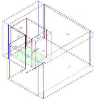
Calcolo di isolamento per via aerea tra il vano emittente "Primo Piano-P1\_ WC" e il vano ricevente "Piano Terra-PT\_ Palestra neuromotoria"
