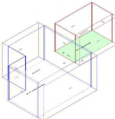
Calcolo di isolamento al calpestio tra il vano emittente "Primo Piano-P1\_ Psicomotrocità" e il vano ricevente "Piano Terra-PT\_ Palestra neuromotoria"
