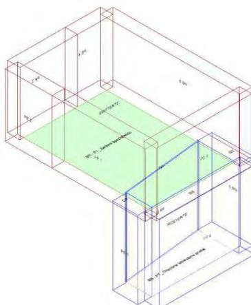
Calcolo di isolamento al calpestio tra il vano emittente "Primo Piano-P1\_ Settore specialistico" e il vano ricevente "Piano Terra-PT\_ Direzione laboratorio analisi"
