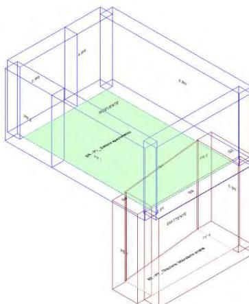
Calcolo di isolamento per via aerea tra il vano emittente "Piano Terra-PT\_ Direzione laboratorio analisi" e il vano ricevente "Primo Piano-P1\_ Settore specialistico"
