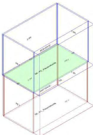
Calcolo di isolamento per via aerea tra il vano emittente "Primo Piano-P1\_ Psicomotrocità" e il vano ricevente "Secondo Piano-P2\_ Psicomotrocità"
