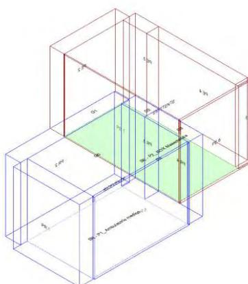
Calcolo di isolamento al calpestio tra il vano emittente "Secondo Piano-P2\_ BOX Massoterapia" e il vano ricevente "Primo Piano-P1\_ Ambulatorio medico"
