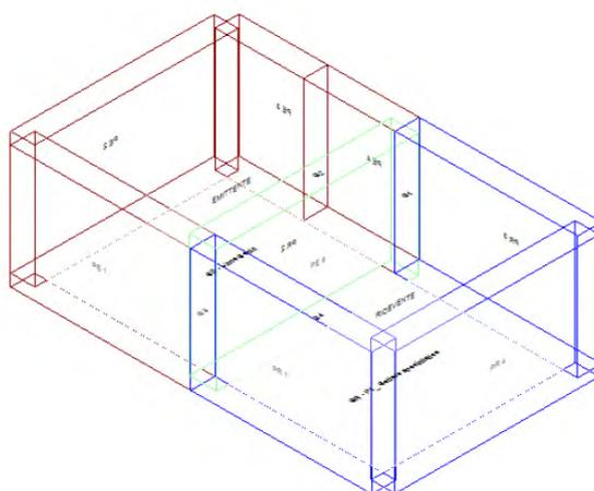
Calcolo di isolamento per via aerea tra il vano emittente "Primo Piano-Vano Scala" e il vano ricevente "Primo Piano-P1\_ Settore specialistico"
