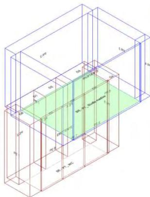
Calcolo di isolamento per via aerea tra il vano emittente "Piano Terra-PT\_ WC" e il vano ricevente "Primo Piano-P1\_ Studio medico"
