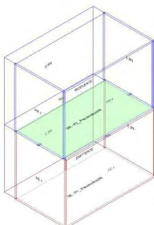
Calcolo di isolamento per via aerea tra il vano emittente "Primo Piano-P1\_ Psicomotrocità" e il vano ricevente "Secondo Piano-P2\_ Psicomotrocità"
