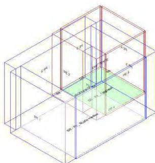
Calcolo di isolamento al calpestio tra il vano emittente "Secondo Piano-P2\_ Spigliatoi" e il vano ricevente "Primo Piano-P1\_ Studio medico"
