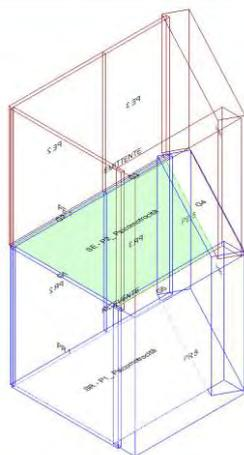
Calcolo di isolamento per via aerea tra il vano emittente "Secondo Piano-P2\_ Psicomotrocità" e il vano ricevente "Primo Piano-P1\_ Psicomotrocità"
