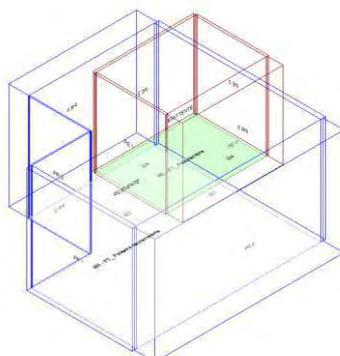
Calcolo di isolamento al calpestio tra il vano emittente "Primo Piano-P1\_ Psicoterapia" e il vano ricevente "Piano Terra-PT\_ Palestra neuromotoria"
