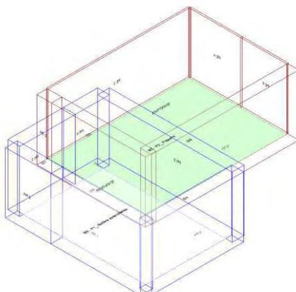
Calcolo di isolamento al calpestio tra il vano emittente "Secondo Piano-P2\_ Palestra" e il vano ricevente "Primo Piano-P1\_ Settore specialistico"
