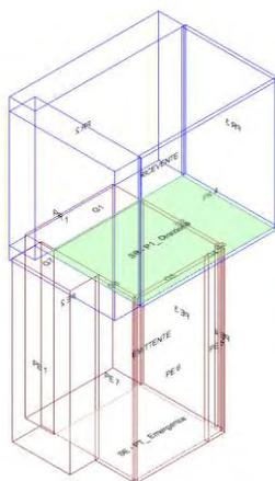
Calcolo di isolamento per via aerea tra il vano emittente "Piano Terra-PT\_ Emergenza" e il vano ricevente "Primo Piano-P1\_ Direzione"
