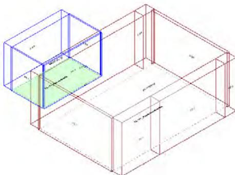
Calcolo di isolamento per via aerea tra il vano emittente "Piano Terra-PT\_ Palestra/semiconvitto" e il vano ricevente "Primo Piano-P1\_ Psicomotrocità"
