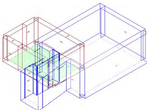
Calcolo di isolamento al calpestio tra il vano emittente "Primo Piano-P1\_ Settore specialistico" e il vano ricevente "Piano Terra-PT\_ Accettazione"
