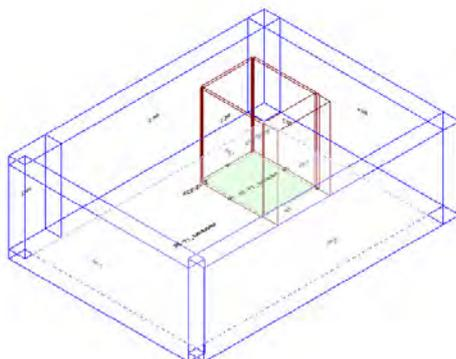
Calcolo di isolamento per via aerea tra il vano emittente "Secondo Piano-P2\_ Spogliatoi" e il vano ricevente "Primo Piano-P1\_ Laboratorio "
