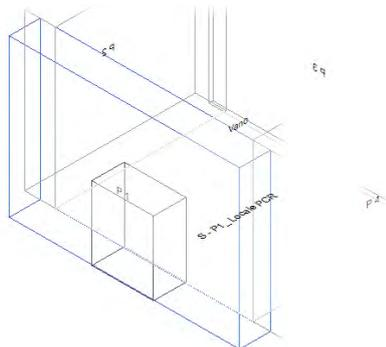
Calcolo di isolamento di facciata per il vano "Primo Piano-P1\_ Locale PCR"
