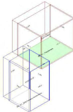
Calcolo di isolamento per via aerea tra il vano emittente "Primo Piano-P1\_ Psicoterapia" e il vano ricevente "Piano Terra-PT\_ BOX Palestra neuromotoria"
