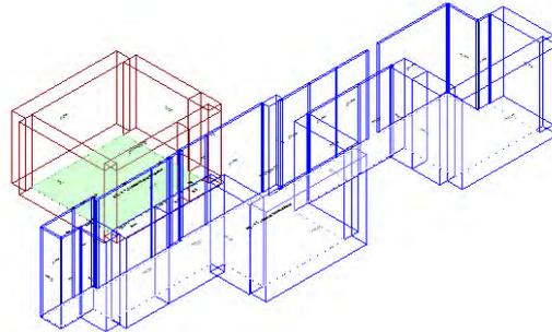
Calcolo di isolamento al calpestio tra il vano emittente "Primo Piano-P1\_ Medicina di laboratorio" e il vano ricevente "Piano Terra-PT\_ Attesa/Accettazione"
