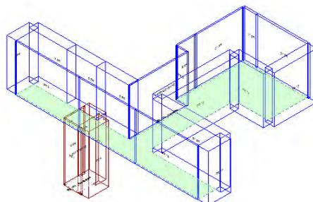
Calcolo di isolamento per via aerea tra il vano emittente "Piano Terra-PT \_Spogliatoio" e il vano ricevente "Primo Piano-P1\_ Corridoio"
