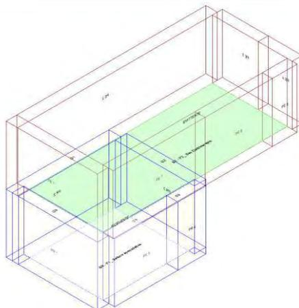
Calcolo di isolamento per via aerea tra il vano emittente "Secondo Piano-P2\_ Box Elettroterapia" e il vano ricevente "Primo Piano-P1\_ Settore specialistico"
