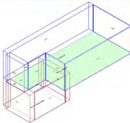
Calcolo di isolamento per via aerea tra il vano emittente "Primo Piano-P1\_ Studio medico" e il vano ricevente "Secondo Piano-P2\_ Palestra"
