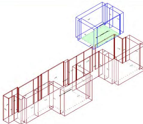
Calcolo di isolamento per via aerea tra il vano emittente "Piano Terra-PT\_ Attesa/Accettazione" e il vano ricevente "Primo Piano-P1\_ Ambulatorio medico"
