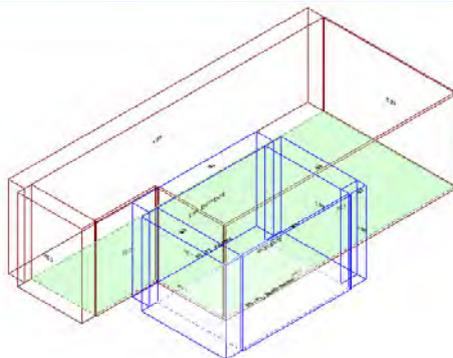
Calcolo di isolamento al calpestio tra il vano emittente "Secondo Piano-P2\_ Palestra" e il vano ricevente "Primo Piano-P1\_ Studio medico"
