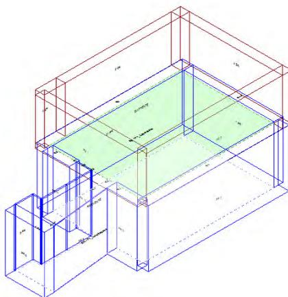
Calcolo di isolamento al calpestio tra il vano emittente "Primo Piano-P1\_ Laboratorio " e il vano ricevente "Piano Terra-PT\_ Accettazione"
