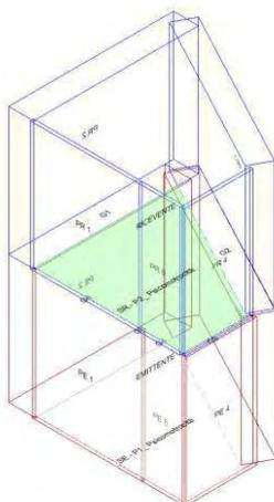
Calcolo di isolamento per via aerea tra il vano emittente "Primo Piano-P1\_ Psicomotrocità" e il vano ricevente "Secondo Piano-P2\_ Psicomotrocità"
