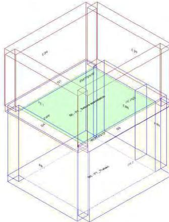
Calcolo di isolamento al calpestio tra il vano emittente "Primo Piano-P1\_ Settore specialistico" e il vano ricevente "Piano Terra-PT\_ Prelievi"
