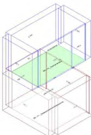
Calcolo di isolamento per via aerea tra il vano emittente "Primo Piano-P1\_ Refetazione/Amministrazione" e il vano ricevente "Secondo Piano-P2\_ Stanza terapia"
