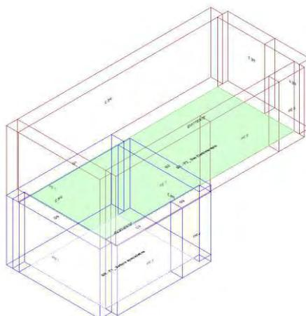
Calcolo di isolamento al calpestio tra il vano emittente "Secondo Piano-P2\_ Box Elettroterapia" e il vano ricevente "Primo Piano-P1\_ Settore specialistico"
