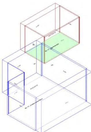
Calcolo di isolamento al calpestio tra il vano emittente "Primo Piano-P1\_ Psicomotrocità" e il vano ricevente "Piano Terra-PT\_ Palestra neuromotoria"
