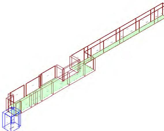
Calcolo di isolamento per via aerea tra il vano emittente "Primo Piano-P1\_ Attesa" e il vano ricevente "Piano Terra-PT\_ Ufficio"
