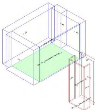
Calcolo di isolamento per via aerea tra il vano emittente "Piano Terra-PT\_ Deposito Sporco" e il vano ricevente "Primo Piano-P1\_ Ambulatorio medico"
