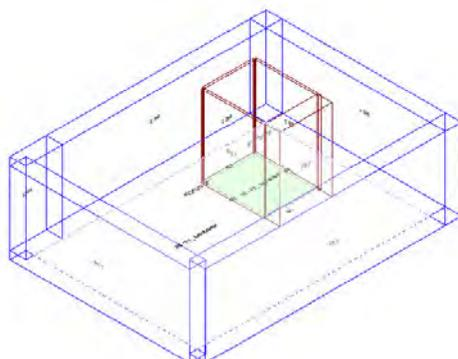
Calcolo di isolamento al calpestio tra il vano emittente "Secondo Piano-P2\_ Spogliatoi" e il vano ricevente "Primo Piano-P1\_ Laboratorio "
