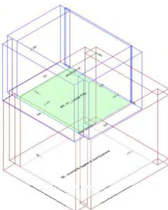
Calcolo di isolamento per via aerea tra il vano emittente "Piano Terra-Area NON oggetto di autorizzazione" e il vano ricevente "Primo Piano-P1\_ Locale PCR"
