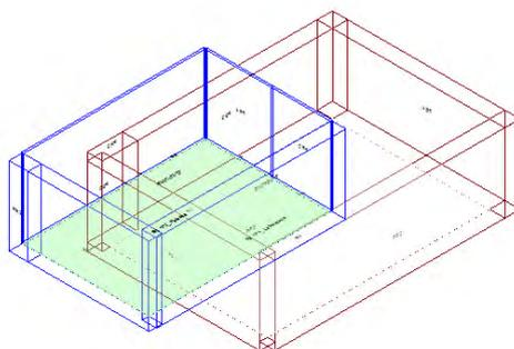
Calcolo di isolamento per via aerea tra il vano emittente "Primo Piano-P1\_ Laboratorio " e il vano ricevente "Secondo Piano-P2\_ Palestra"
