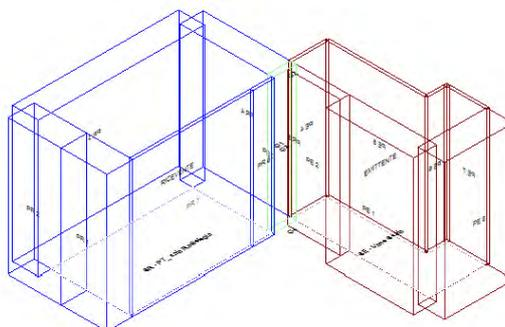
Calcolo di isolamento per via aerea tra il vano emittente "Piano Terra-Vano Scala" e il vano ricevente "Piano Terra-PT\_ sala Radiologia"
