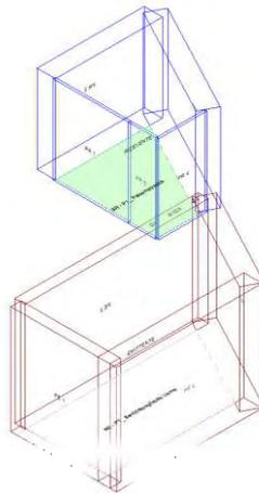
Calcolo di isolamento per via aerea tra il vano emittente "Piano Terra-PT\_ Sevizi/Spogliatoio Uomo" e il vano ricevente "Primo Piano-P1\_ Psicomotrocità"
