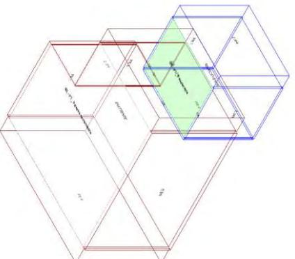
Calcolo di isolamento per via aerea tra il vano emittente "Piano Terra-PT\_ Palestra neuromotoria" e il vano ricevente "Primo Piano-P1\_ Psicoterapia"
