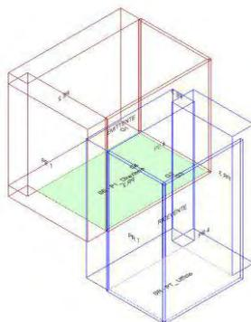
Calcolo di isolamento al calpestio tra il vano emittente "Primo Piano-P1\_ Direzione" e il vano ricevente "Piano Terra-PT\_ Ufficio"
