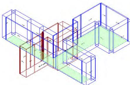
Calcolo di isolamento per via aerea tra il vano emittente "Piano Terra-PT\_Attesa" e il vano ricevente "Primo Piano-P1\_Corridoio"
