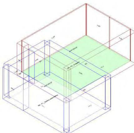
Calcolo di isolamento per via aerea tra il vano emittente "Secondo Piano-P2\_ Palestra" e il vano ricevente "Primo Piano-P1\_Settore specialistico"
