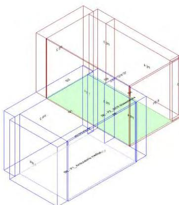
Calcolo di isolamento per via aerea tra il vano emittente "Secondo Piano-P2\_ BOX Massoteriaia" e il vano ricevente "Primo Piano-P1\_ Ambulatorio medico"
