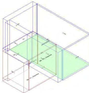
Calcolo di isolamento per via aerea tra il vano emittente "Primo Piano-P1\_ Direzione" e il vano ricevente "Secondo Piano-P2\_ Direzione"
