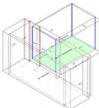
Calcolo di isolamento per via aerea tra il vano emittente "Piano Terra-Vano Scala" e il vano ricevente "Primo Piano-P1\_ Psicomotrocità"
