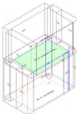
Calcolo di isolamento al calpestio tra il vano emittente "Primo Piano-P1\_ Ambulatorio medico" e il vano ricevente "Piano Terra-PT\_ sala Radiologia"
