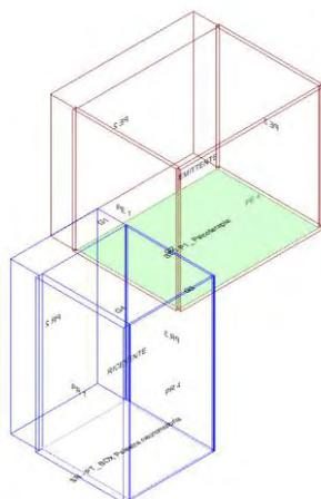
Calcolo di isolamento al calpestio tra il vano emittente "Primo Piano-P1\_ Psicoterapia" e il vano ricevente "Piano Terra-PT\_ BOX Palestra neuromotoria"
