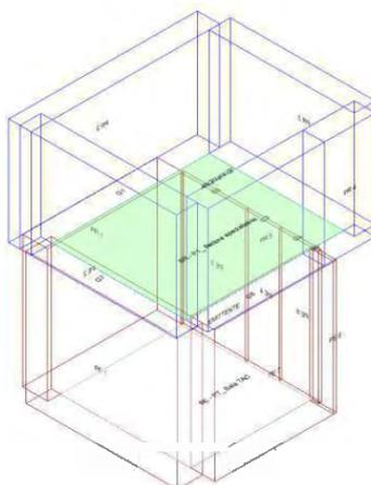
Calcolo di isolamento per via aerea tra il vano emittente "Piano Terra-PT\_ Sala TAC" e il vano ricevente "Primo Piano-P1\_ Settore specialistico"
