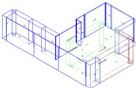
Calcolo di isolamento per via aerea tra il vano emittente "Primo Piano-Vano Scala" e il vano ricevente "Primo Piano-P1\_ Corridoio"
