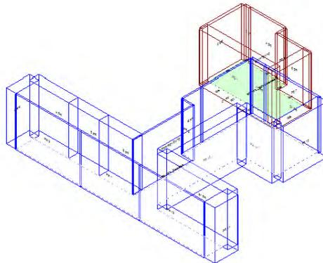
Calcolo di isolamento per via aerea tra il vano emittente "Secondo Piano-P2\_ BOX Isocinetica" e il vano ricevente "Primo Piano-P1\_ Corridoio"
