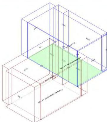
Calcolo di isolamento per via aerea tra il vano emittente "Primo Piano-P1\_ Ambulatorio medico" e il vano ricevente "Secondo Piano-P2\_ BOX Massoterapia"
