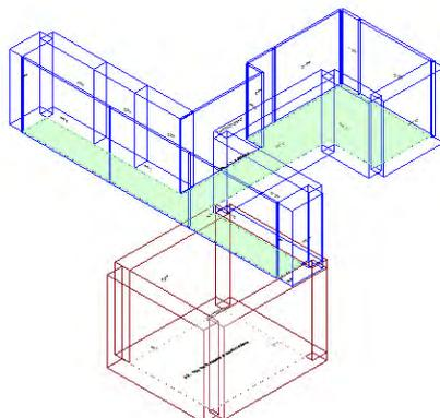
Calcolo di isolamento per via aerea tra il vano emittente "Piano Terra-Area NON oggetto di autorizzazione" e il vano ricevente "Primo Piano-P1\_Corridoio"
