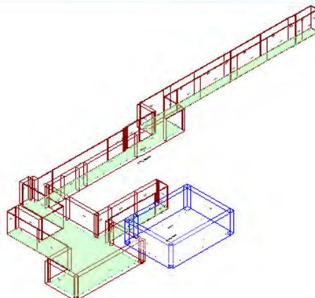
Calcolo di isolamento al calpestio tra il vano emittente "Secondo Piano-P2\_ Attesa/Corridoio" e il vano ricevente "Primo Piano-P1\_ Laboratorio "
