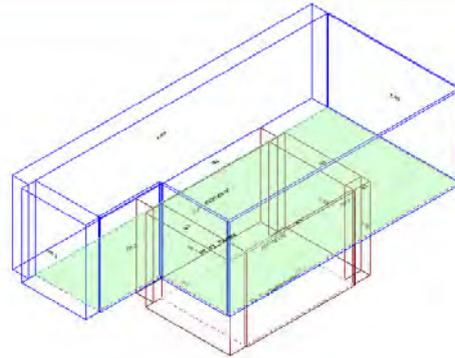
Calcolo di isolamento per via aerea tra il vano emittente "Primo Piano-P1\_ Studio medico" e il vano ricevente "Secondo Piano-P2\_ Palestra"
