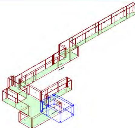
Calcolo di isolamento per via aerea tra il vano emittente "Secondo Piano-P2\_ Attesa/Corridoio" e il vano ricevente "Primo Piano-P1\_ Settore specialistico"
