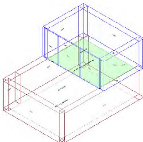
Calcolo di isolamento per via aerea tra il vano emittente "Primo Piano-P1\_ Laboratorio " e il vano ricevente "Secondo Piano-P2\_ Box Terapia strumentale"
