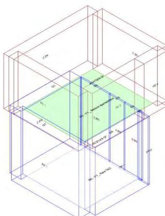
Calcolo di isolamento per via aerea tra il vano emittente "Primo Piano-P1\_ Settore specialistico" e il vano ricevente "Piano Terra-PT\_ Sala TAC"
