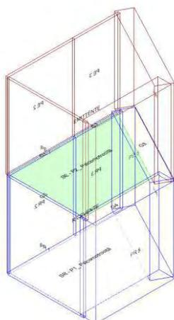
Calcolo di isolamento al calpestio tra il vano emittente "Secondo Piano-P2\_ Psicomotrocità" e il vano ricevente "Primo Piano-P1\_ Psicomotrocità"
