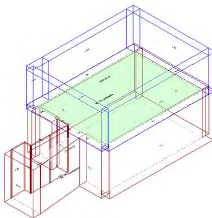
Calcolo di isolamento per via aerea tra il vano emittente "Piano Terra-PT\_ Accettazione" e il vano ricevente "Primo Piano-P1\_ Laboratorio "
