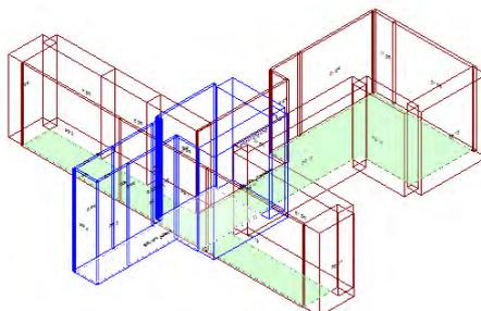
Calcolo di isolamento al calpestio tra il vano emittente "Primo Piano-P1\_ Corridoio" e il vano ricevente "Piano Terra-PT\_Attesa"
