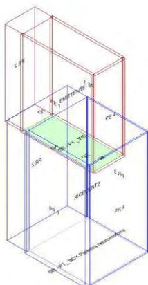
Calcolo di isolamento al calpestio tra il vano emittente "Primo Piano-P1\_ WC" e il vano ricevente "Piano Terra-PT\_ BOX Palestra neuromotoria"
