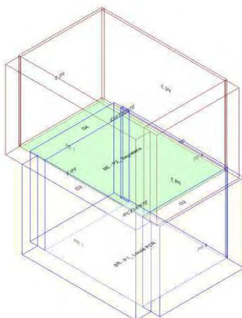
Calcolo di isolamento per via aerea tra il vano emittente "Secondo Piano-P2\_ Segreteria" e il vano ricevente "Primo Piano-P1\_ Locale PCR"
