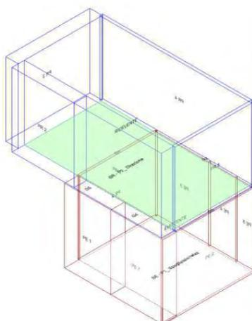
Calcolo di isolamento per via aerea tra il vano emittente "Primo Piano-P1\_ Spogliatoio/relax" e il vano ricevente "Secondo Piano-P2\_ Direzione"
