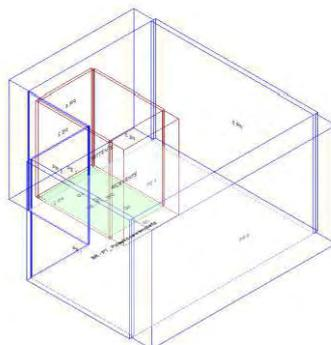
Calcolo di isolamento al calpestio tra il vano emittente "Primo Piano-P1\_ WC" e il vano ricevente "Piano Terra-PT\_ Palestra neuromotoria"
