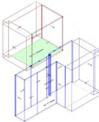
Calcolo di isolamento per via aerea tra il vano emittente "Primo Piano-P1\_ Direzione" e il vano ricevente "Piano Terra-PT\_Attesa"
