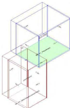
Calcolo di isolamento per via aerea tra il vano emittente "Piano Terra-PT\_ BOX Palestra neuromotoria" e il vano ricevente "Primo Piano-P1\_ Psicoterapia"
