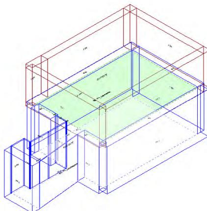
Calcolo di isolamento per via aerea tra il vano emittente "Primo Piano-P1\_ Laboratorio " e il vano ricevente "Piano Terra-PT\_ Accettazione"
