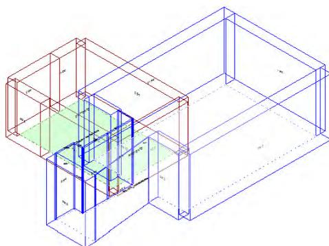
Calcolo di isolamento per via aerea tra il vano emittente "Primo Piano-P1\_ Settore specialistico" e il vano ricevente "Piano Terra-PT\_ Accettazione"
