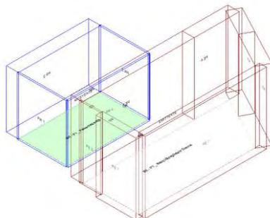
Calcolo di isolamento per via aerea tra il vano emittente "Piano Terra-PT\_ Sevizi/Spogliatoio Donne" e il vano ricevente "Primo Piano-P1\_ Psicomotrocità"
