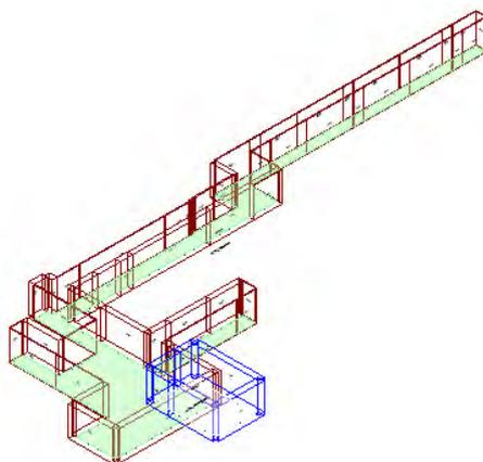
Calcolo di isolamento al calpestio tra il vano emittente "Secondo Piano-P2\_ Attesa/Corridoio" e il vano ricevente "Primo Piano-P1\_ Settore specialistico"
