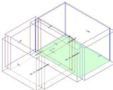
Calcolo di isolamento per via aerea tra il vano emittente "Primo Piano-P1\_ Deposito materiali" e il vano ricevente "Secondo Piano-P2\_ Segreteria"
