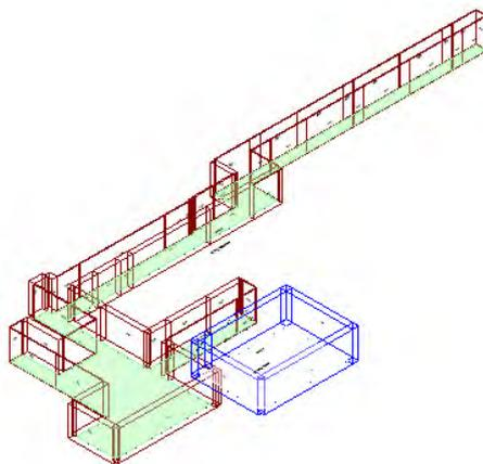
Calcolo di isolamento per via aerea tra il vano emittente "Secondo Piano-P2\_ Attesa/Corridoio" e il vano ricevente "Primo Piano-P1\_ Laboratorio "
