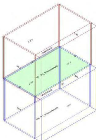
Calcolo di isolamento per via aerea tra il vano emittente "Secondo Piano-P2\_ Psicomotrocità" e il vano ricevente "Primo Piano-P1\_ Psicomotrocità"
