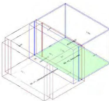
Calcolo di isolamento per via aerea tra il vano emittente "Primo Piano-P1\_ Refetazione/Amministrazione" e il vano ricevente "Secondo Piano-P2\_ Stanza visite"
