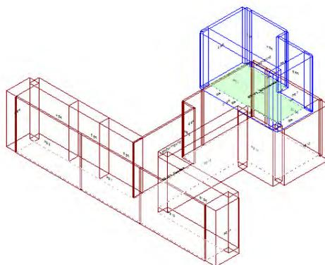
Calcolo di isolamento per via aerea tra il vano emittente "Primo Piano-P1\_ Corridoio" e il vano ricevente "Secondo Piano-P2\_ BOX Isocinetica"
