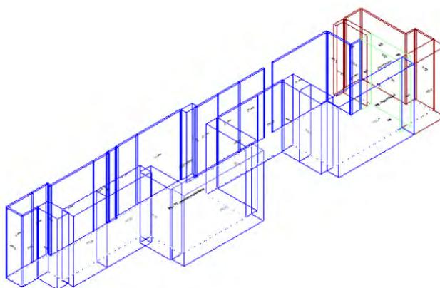
Calcolo di isolamento per via aerea tra il vano emittente "Piano Terra-Vano Scala" e il vano ricevente "Piano Terra-PT\_ Attesa/Acettazione"
