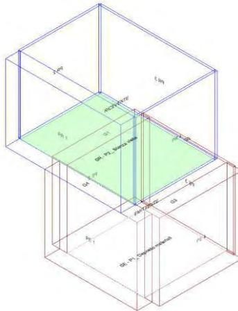
Calcolo di isolamento per via aerea tra il vano emittente "Primo Piano-P1\_ Deposito materiali" e il vano ricevente "Secondo Piano-P2\_ Stanza visite"
