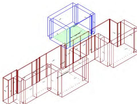
Calcolo di isolamento per via aerea tra il vano emittente "Piano Terra-PT\_ Attesa/Acettazione" e il vano ricevente "Primo Piano-P1\_ Studio medico"
