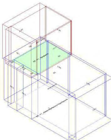
Calcolo di isolamento per via aerea tra il vano emittente "Primo Piano-P1\_ Spogliatoio" e il vano ricevente "Piano Terra-PT\_ Attesa/Accettazione Riabilitazione"
