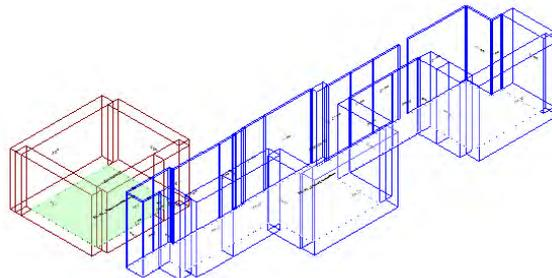
Calcolo di isolamento per via aerea tra il vano emittente "Primo Piano-P1\_ Settore specialistico" e il vano ricevente "Piano Terra-PT\_ Attesa/Accettazione"
