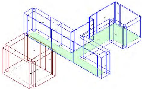
Calcolo di isolamento per via aerea tra il vano emittente "Piano Terra-PT\_Sala RM" e il vano ricevente "Primo Piano-P1\_Corridoio"
