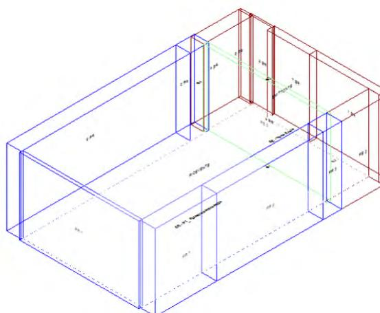
Calcolo di isolamento per via aerea tra il vano emittente "Piano Terra-Vano Scala" e il vano ricevente "Piano Terra-PT\_ Palestra/semiconvitto"
