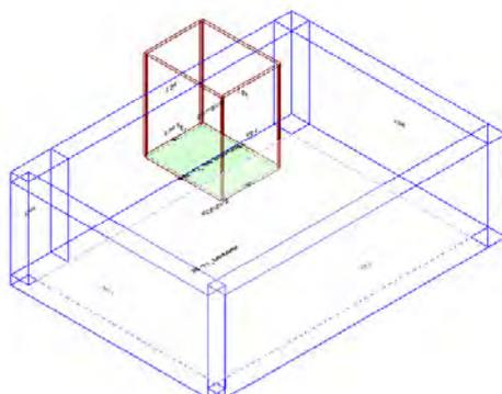
Calcolo di isolamento per via aerea tra il vano emittente "Secondo Piano-P2\_ Box Tecarterapia" e il vano ricevente "Primo Piano-P1\_ Laboratorio "
