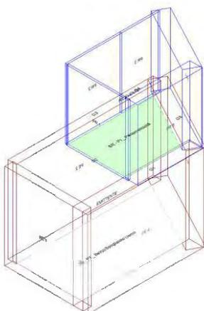
Calcolo di isolamento per via aerea tra il vano emittente "Piano Terra-PT\_ Servizi/Spogliatoio Uomo" e il vano ricevente "Primo Piano-P1\_ Psicomotrocità"
