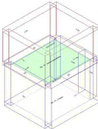
Calcolo di isolamento per via aerea tra il vano emittente "Primo Piano-P1\_ Settore specialistico" e il vano ricevente "Piano Terra-PT\_ Prelievi"
