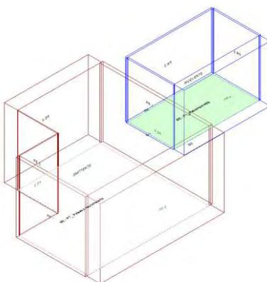
Calcolo di isolamento per via aerea tra il vano emittente "Piano Terra-PT\_ Palestra neuromotoria" e il vano ricevente "Primo Piano-P1\_ Psicomotrocità"
