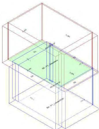
Calcolo di isolamento al calpestio tra il vano emittente "Secondo Piano-P2\_ Segreteria" e il vano ricevente "Primo Piano-P1\_ Locale PCR"
