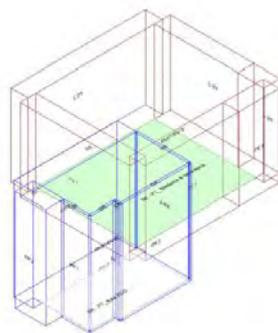
Calcolo di isolamento al calpestio tra il vano emittente "Primo Piano-P1\_ Medicina di laboratorio" e il vano ricevente "Piano Terra-PT\_ Sala ECO"
