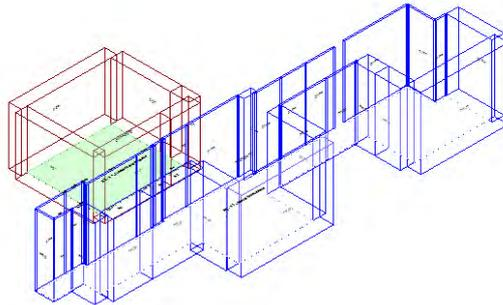
Calcolo di isolamento per via aerea tra il vano emittente "Primo Piano-P1\_ Medicina di laboratorio" e il vano ricevente "Piano Terra-PT\_ Attesa/Accettazione"
