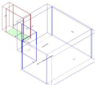
Calcolo di isolamento per via aerea tra il vano emittente "Primo Piano-P1\_ WC" e il vano ricevente "Piano Terra-PT\_ Palestra neuromotoria"
