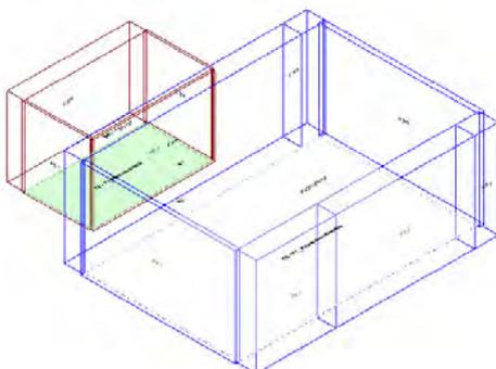
Calcolo di isolamento per via aerea tra il vano emittente "Primo Piano-P1\_ Psicomotrocità" e il vano ricevente "Piano Terra-PT\_ Palestra/semiconvitto"
