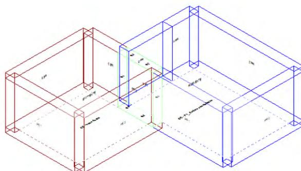
Calcolo di isolamento per via aerea tra il vano emittente "Primo Piano-Vano Scala" e il vano ricevente "Primo Piano-P1\_ Settore specialistico"
