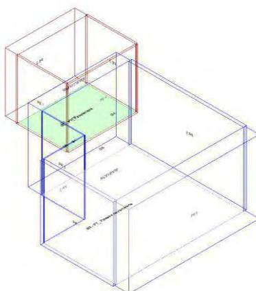
Calcolo di isolamento al calpestio tra il vano emittente "Primo Piano-P1\_ Psicoterapia" e il vano ricevente "Piano Terra-PT\_ Palestra neuromotoria"
