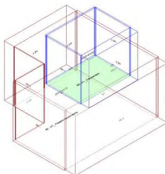
Calcolo di isolamento per via aerea tra il vano emittente "Piano Terra-PT\_ Palestra neuromotoria" e il vano ricevente "Primo Piano-P1\_ Psicoterapia"
