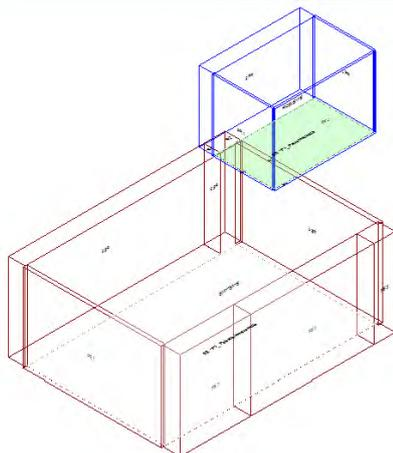
Calcolo di isolamento per via aerea tra il vano emittente "Piano Terra-PT\_ Palestra/semiconvitto" e il vano ricevente "Primo Piano-P1\_ Psicomotrocità"
