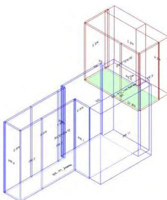
Calcolo di isolamento al calpestio tra il vano emittente "Primo Piano-P1\_ Loc.Server" e il vano ricevente "Piano Terra-PT\_Attesa"
