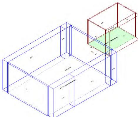
Calcolo di isolamento per via aerea tra il vano emittente "Primo Piano-P1\_ Psicomotrocità" e il vano ricevente "Piano Terra-PT\_ Palestra/semiconvitto"
