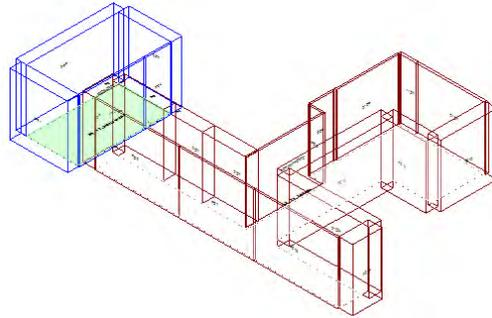
Calcolo di isolamento per via aerea tra il vano emittente "Primo Piano-P1\_ Corridoio" e il vano ricevente "Secondo Piano-P2\_ Stanza terapia"
