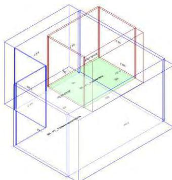
Calcolo di isolamento per via aerea tra il vano emittente "Primo Piano-P1\_ Psicoterapia" e il vano ricevente "Piano Terra-PT\_ Palestra neuromotoria"
