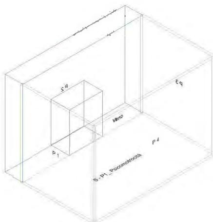
Calcolo di isolamento di facciata per il vano "Primo Piano-P1\_ Psicomotrocità"
