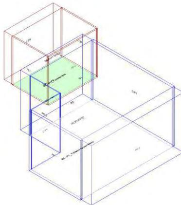
Calcolo di isolamento per via aerea tra il vano emittente "Primo Piano-P1\_ Psicoterapia" e il vano ricevente "Piano Terra-PT\_ Palestra neuromotoria"
