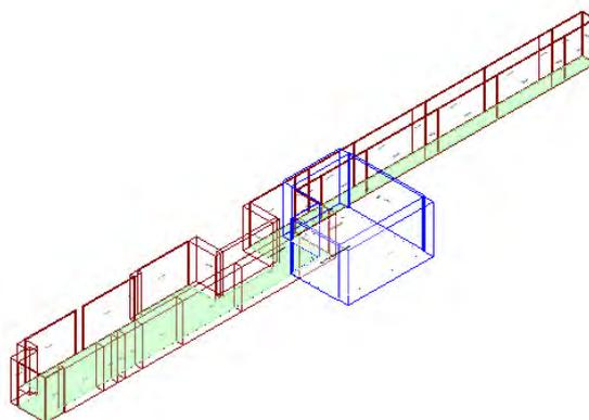
Calcolo di isolamento per via aerea tra il vano emittente "Primo Piano-P1\_ Attesa" e il vano ricevente "Piano Terra-PT\_ Palestra neuromotoria"
