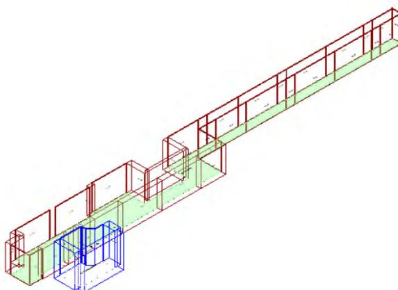
Calcolo di isolamento per via aerea tra il vano emittente "Primo Piano-P1\_ Attesa" e il vano ricevente "Piano Terra-PT\_ Sala Radiologia"
