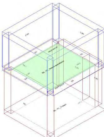
Calcolo di isolamento per via aerea tra il vano emittente "Piano Terra-PT\_ Prelievi" e il vano ricevente "Primo Piano-P1\_ Settore specialistico"
