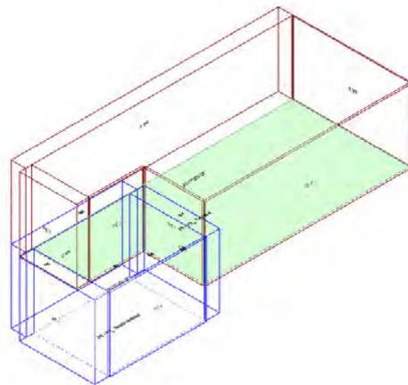
Calcolo di isolamento per via aerea tra il vano emittente "Secondo Piano-P2\_ Palestra" e il vano ricevente "Primo Piano-P1\_ Studio medico"
