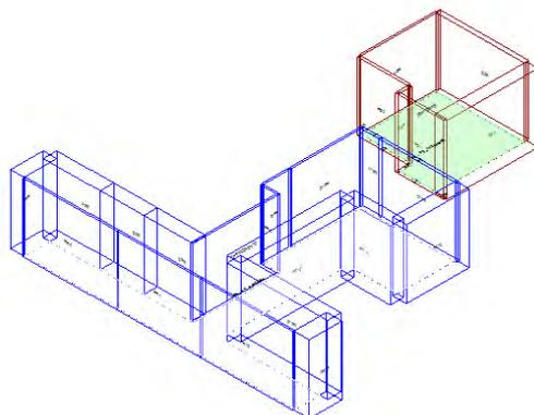
Calcolo di isolamento al calpestio tra il vano emittente "Secondo Piano-P2\_ WC Utenti" e il vano ricevente "Primo Piano-P1\_ Corridoio"
