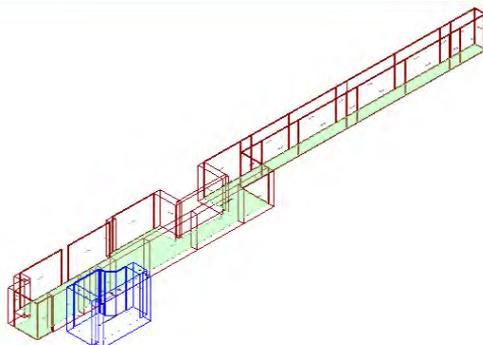
Calcolo di isolamento al calpestio tra il vano emittente "Primo Piano-P1\_ Attesa" e il vano ricevente "Piano Terra-PT\_ Sala Radiologia"
