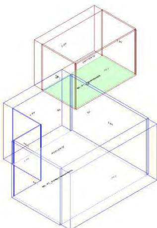
Calcolo di isolamento per via aerea tra il vano emittente "Primo Piano-P1\_ Psicomotrocità" e il vano ricevente "Piano Terra-PT\_ Palestra neuromotoria"
