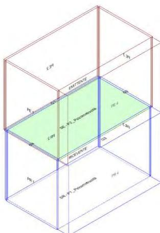
Calcolo di isolamento al calpestio tra il vano emittente "Secondo Piano-P2\_ Psicomotrocità" e il vano ricevente "Primo Piano-P1\_ Psicomotrocità"
