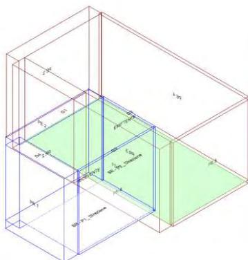
Calcolo di isolamento al calpestio tra il vano emittente "Secondo Piano-P2\_ Direzione" e il vano ricevente "Primo Piano-P1\_ Direzione"
