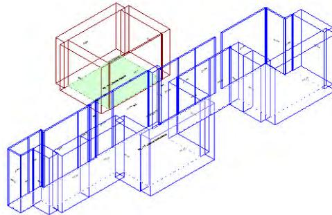
Calcolo di isolamento per via aerea tra il vano emittente "Primo Piano-P1\_ Studio medico" e il vano ricevente "Piano Terra-PT\_ Attesa/Accettazione"
