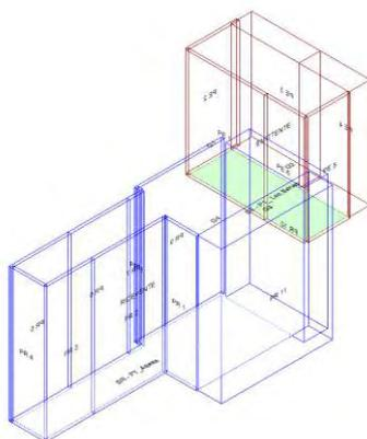
Calcolo di isolamento per via aerea tra il vano emittente "Primo Piano-P1\_ Loc.Server" e il vano ricevente "Piano Terra-PT\_Attesa"
