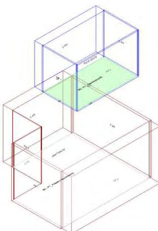
Calcolo di isolamento per via aerea tra il vano emittente "Piano Terra-PT\_ Palestra neuromotoria" e il vano ricevente "Primo Piano-P1\_ Psicomotrocità"
