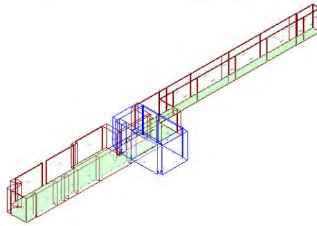
Calcolo di isolamento per via aerea tra il vano emittente "Primo Piano-P1\_ Attesa" e il vano ricevente "Piano Terra-PT\_ Attesa/Acettazione Riabilitazione"
