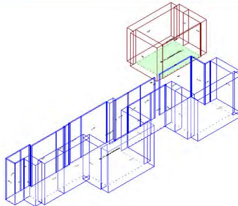
Calcolo di isolamento per via aerea tra il vano emittente "Primo Piano-P1\_ Ambulatorio medico" e il vano ricevente "Piano Terra-PT\_ Attesa/Accettazione"
