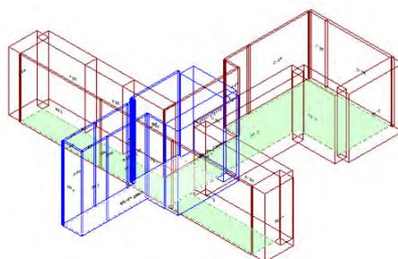
Calcolo di isolamento per via aerea tra il vano emittente "Primo Piano-P1\_Corridoio" e il vano ricevente "Piano Terra-PT\_Attesa"
