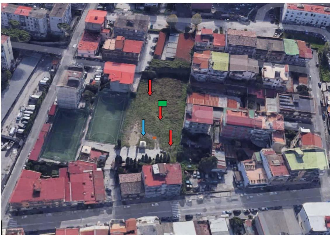
Ubicazione indagini: ↓ Sondaggio a carotaggio continuo; ↓ Prove penetrometriche DPSH;
