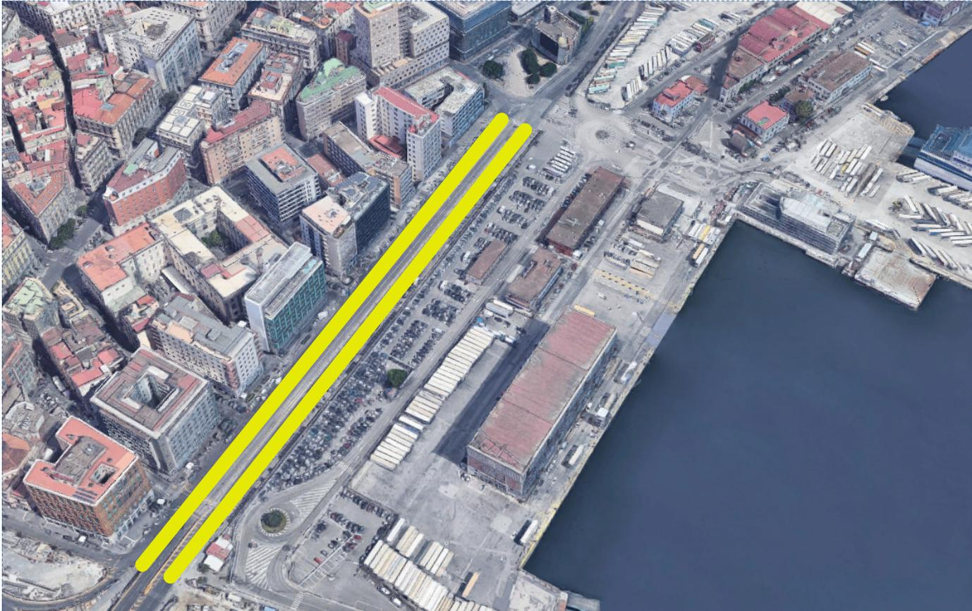
Sostituzione della pavimentazione esistente in elementi lapidei con una nuova pavimentazione in conglomerato bituminoso sulla carreggiata lato monte di via Cristoforo Colombo.
