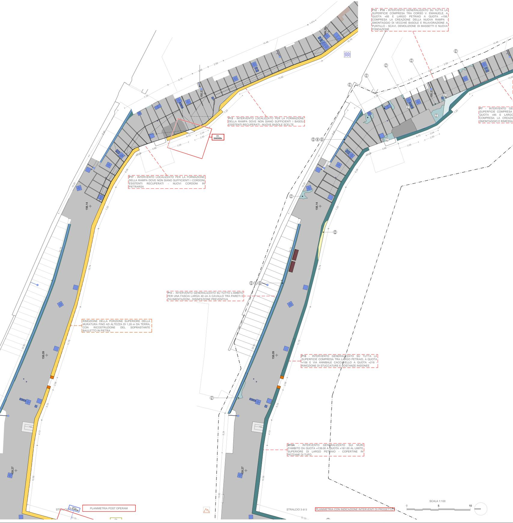
P12 - INTERVENTO GENERALIZZATO SU TUTTA LA SUPERFICIE COMPRESA TRA CORSO V. EMANUELE A QUOTA +85 E LARGO PETRAIO A QUOTA +156. COMPRESA LA CREAZIONE DELLA NUOVA RAMPA (SMONTAGGIO DI VECCHIE BASOLE E RILAVORAZIONE A PUNTILLO - SCAVI, DEMOLIZIONE DI MASSETTI E NUOVA FONDAZIONE)
