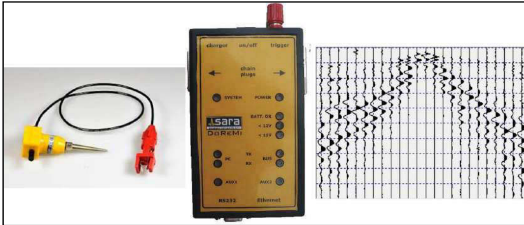
Figura 23: Sismografo DOREMI della Sara Instruments.
