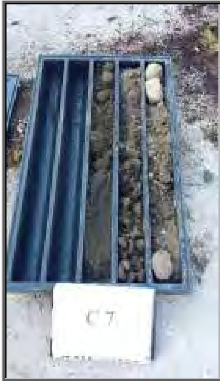
*Cassetta catalogatrice carote Sondaggio "C7" da 0,00 metri a 3,00 metri*
