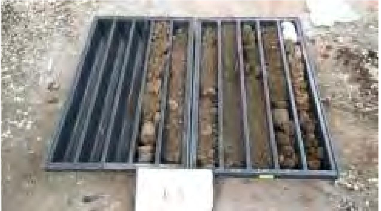
***Cassetta catalogatrice carote Sondaggio "C3" da 0,00 metri a 7,00 metri***
