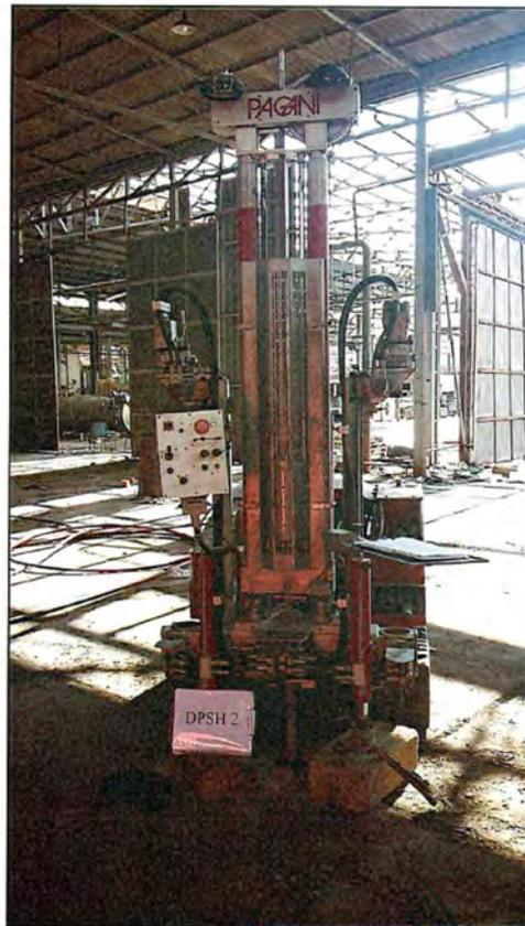
Particolare esecuzione prova DPSH P2
