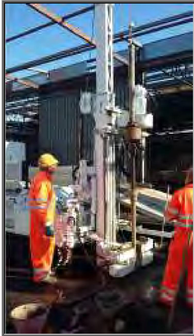
*Prova SPT1 in foro alla profondità di 12,50 metri*
