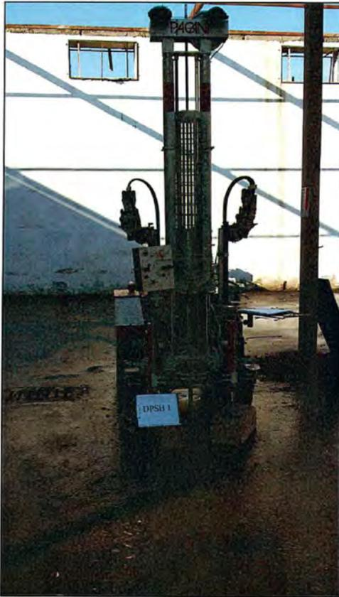
Particolare esecuzione prova DPSH P1
