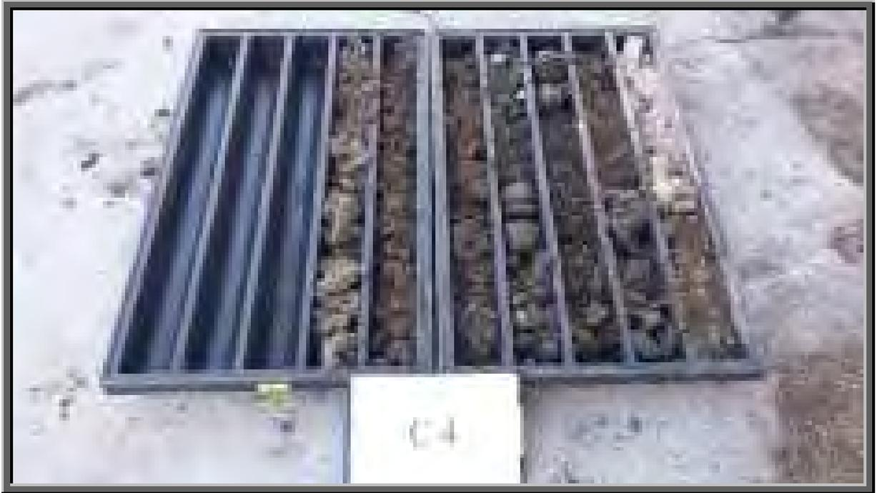
*Cassetta catalogatrice carote Sondaggio "C4" da 0,00 metri a 7,00 metri*
