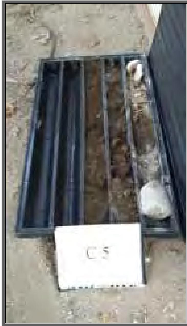
*Cassetta catalogatrice carote Sondaggio "C5" da 0,00 metri a 3,00 metri*
