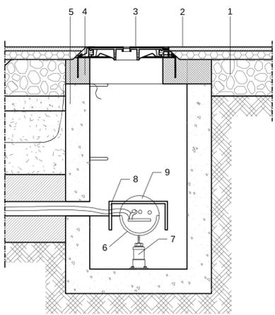
**POZZETTO DI DERIVAZIONE PER ALLACCI SINGOLI**
