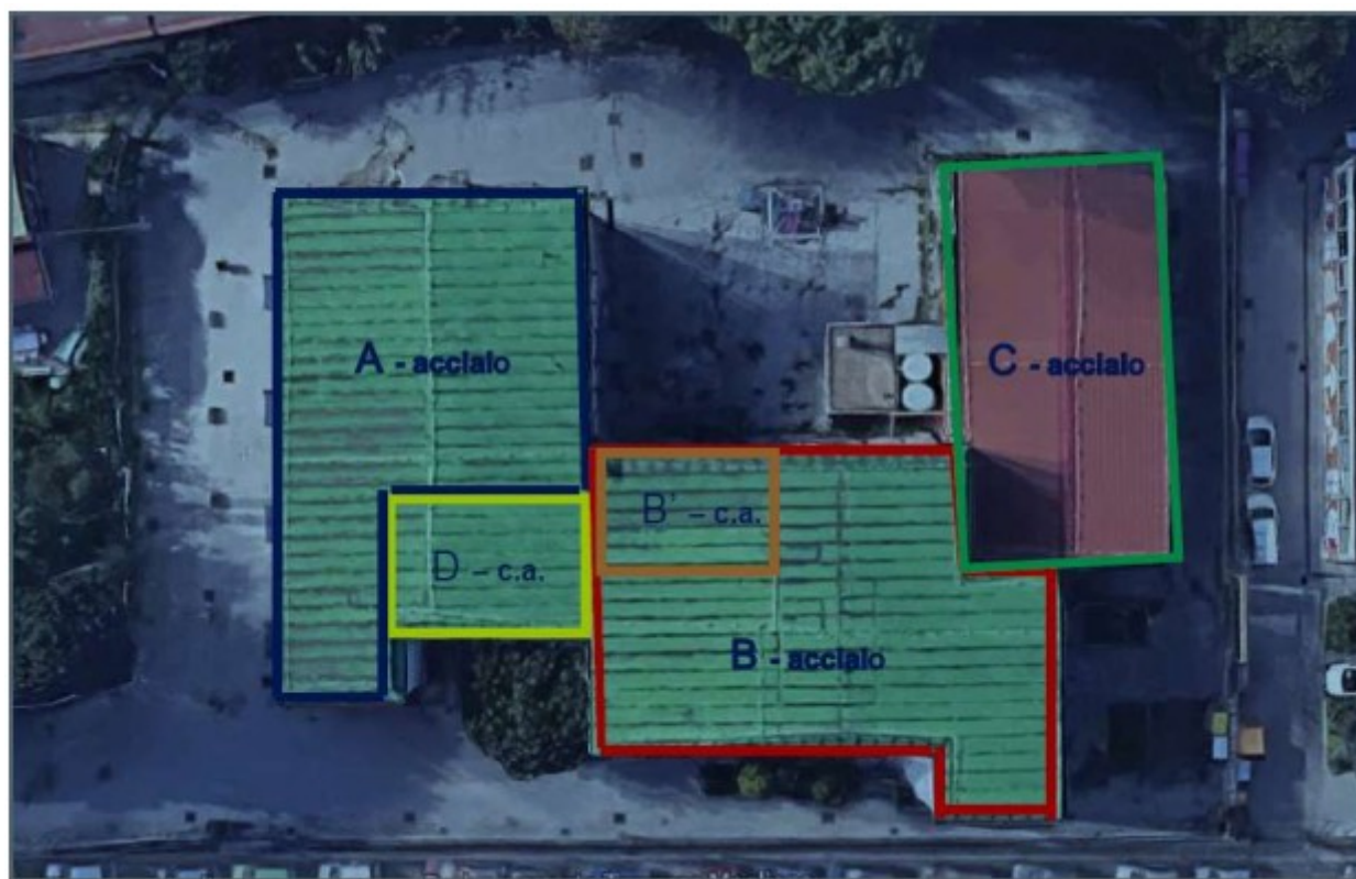
Figura 10 – schema planimetrico con individuazione dei corpi strutturali
