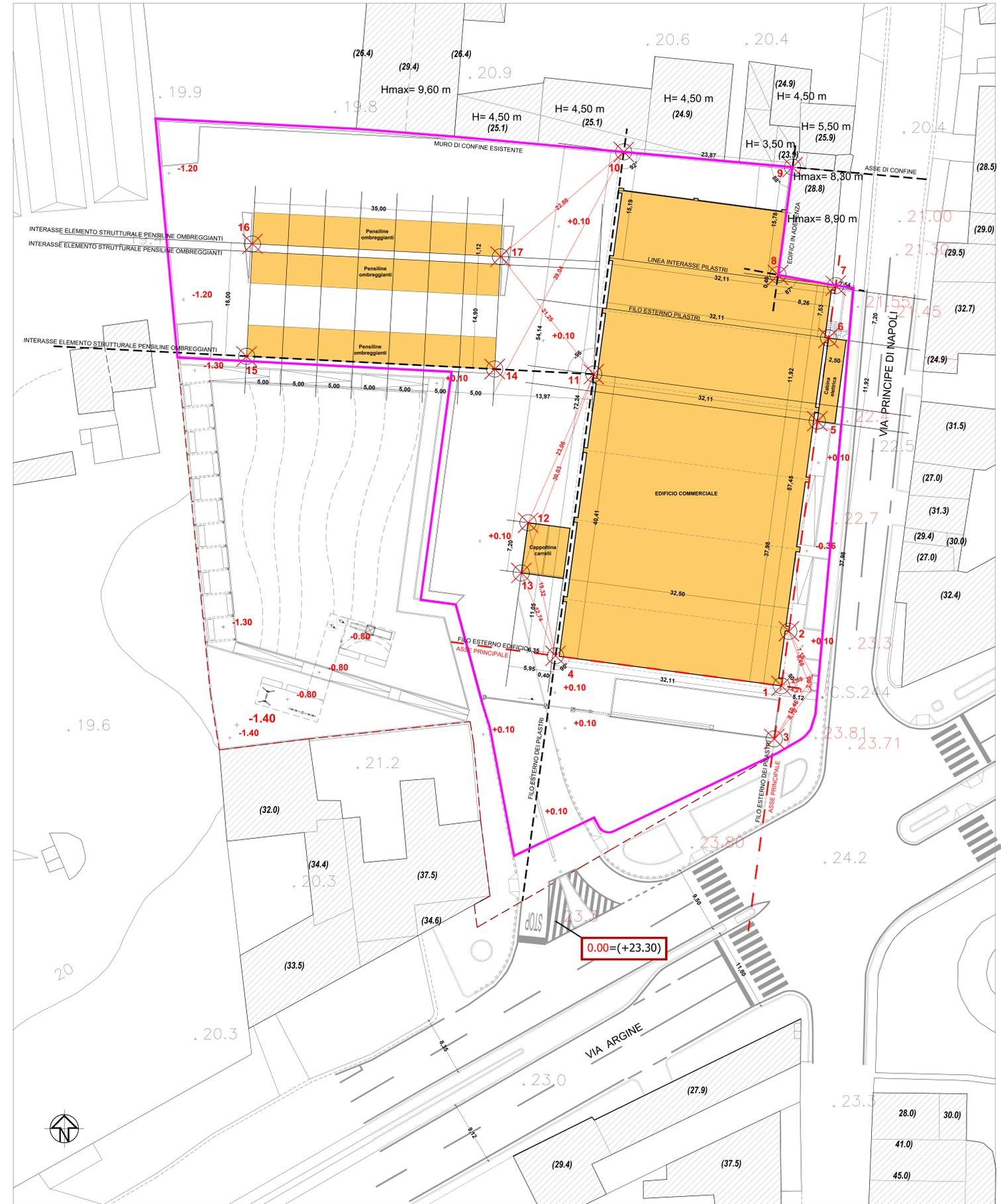
COSTRUZIONE DELLA POLIGONALE E DEGLI ASSI PRINCIPALI NECESSARI A DETERMINARE I PUNTI FISSI D'IMPIANTO DEL NUOVO EDIFICIO E TRILATERAZIONE CON INDIVIDUAZIONE DEI PUNTI FISSI RISCONTRABILI IN LOCO ANCHE POST DEMOLIZIONI, A CANTIERE IN CORSO E AD OPERE ULTIMATE - SCALA 1:50
