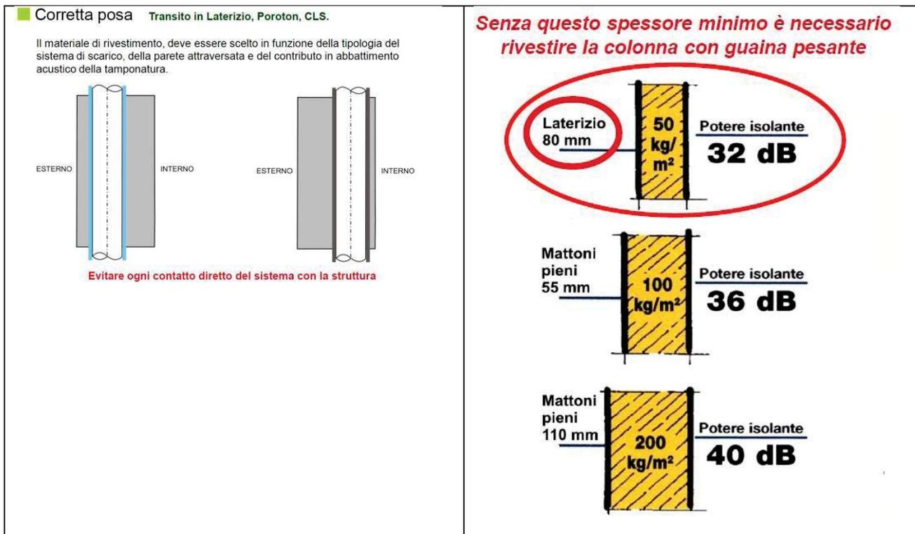
Fig. 1 – schemi tipo delle problematiche degli scarichi idraulici
