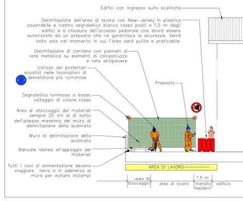
TIPOLOGICO PER GARANTIRE L'ACCESSO AI FABBRICATI DOPO LA DEMOLIZIONE DEI GRADINI DI ACCESSO ALLE ABITAZIONI RIPRISTINARE GLI STESSI IN MANIERA PROVVISORIA CON TAVOLATI DI LEGNO E SABBIA, QUI IL SEGUITO RIPIANTA UN CASO TIPO E UN ELEMENTO DI OPERA PROVVISORIA.
