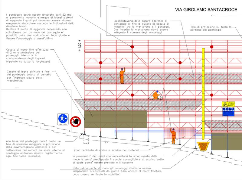
FASI DI MONTAGGIO E SMONTAGGIO DEL PONTEGGIO, CORRETTO UTILIZZO E PARTICOLARE DEL TIRO MANUALE
