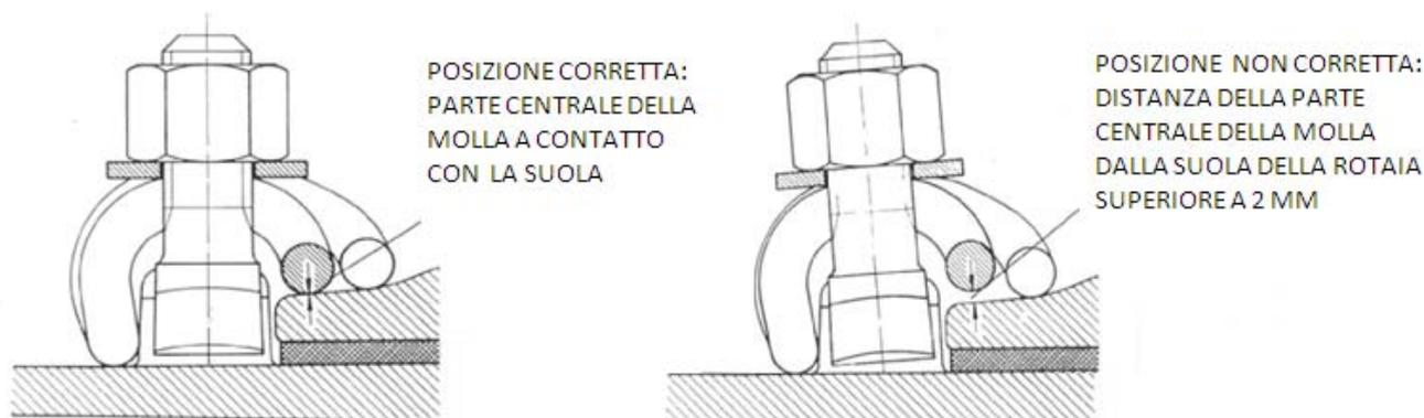
Per il serraggio della controrotaia 33C1 viene impiegato un dado autobloccante M22; a seconda del fornitore del kit completo della piastra per controrotaia, sono attualmente in uso i seguenti dadi:
