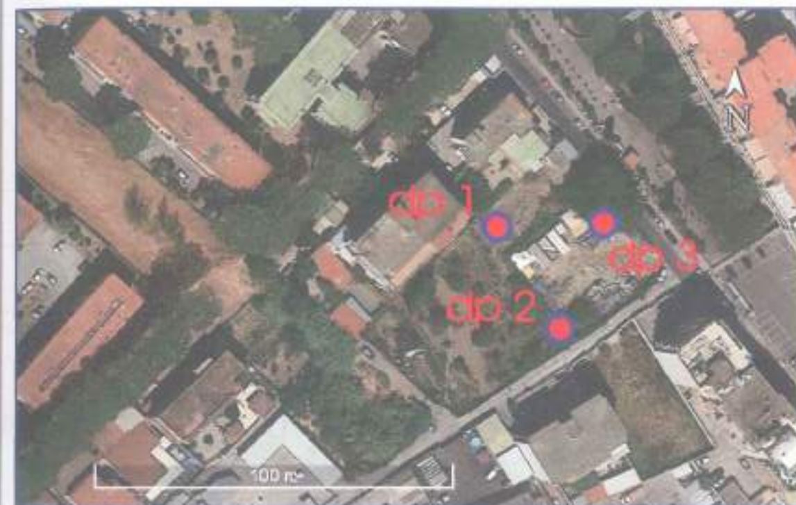
FIG. 4 – AEROFOTOGRAMMETRIA DELL'AREA CON UBICAZIONE DEI SONDAGGI PENETROMETRICI
