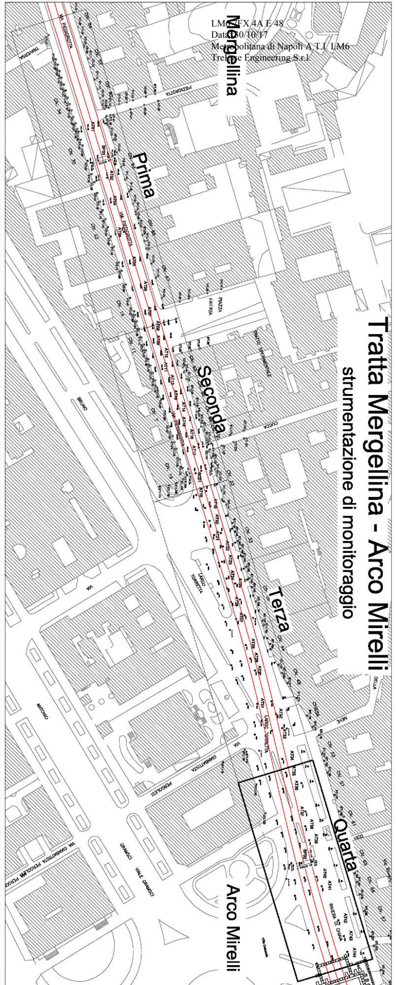
Figura 4.4.: Planimetria tratta Mergellina - Arco Mirelli, raffigurante la disposizione della quarta installazione della strumentazione di monitoraggio.
