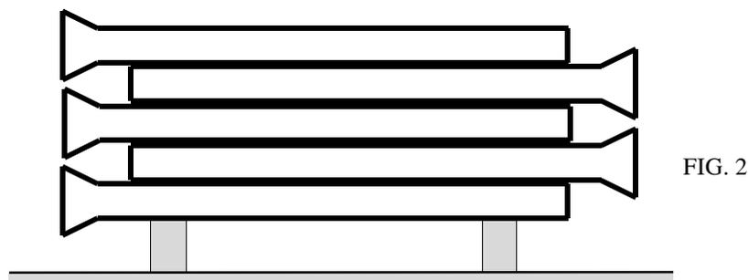
Con l'uno o l'altro sistema verranno limitate le altezze delle pile e, quindi, il numero degli strati in funzione inversa del diametro dei tubi, allo scopo di non sovraccaricare i tubi degli strati inferiori. Il numero massimo di strati sarà il seguente:
